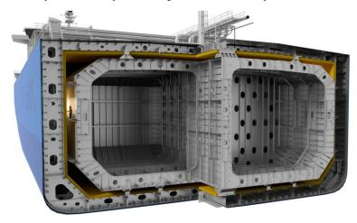
Рис. 19. Танкер-газовоз с мембранной емкостью в разрезе [110, 111]
