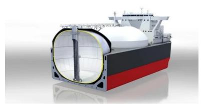
**Рис. 18.** Сферические танки типа Moss [110, 111]
