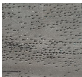
Рис. 1. Никелевая пластина, покрытая питтингом
