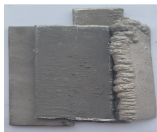
Рис. 2. Обрезь никелевых катодов
