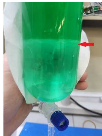
Рис. 2. Третья фаза на границе раздела фаз при экстракции никеля при pH = 6,5
