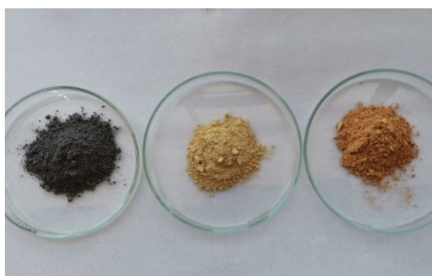
Рис. 2. Изображение исходного и полученного продуктов: Перовскит (исх) → гидратированный продукт → прокаленный продукт
