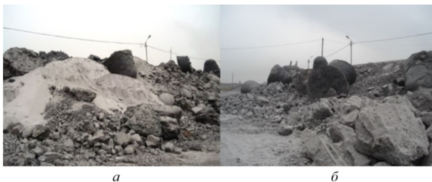
Рис. 4. Вид распавшегося (а) и стабилизированного (б) шлака рафинированного феррохрома АЗФ
