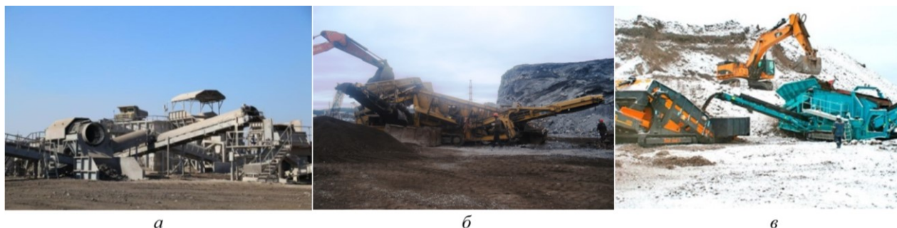
Рис. 1. Сортировочные агрегаты для переработки отвального шлака:
