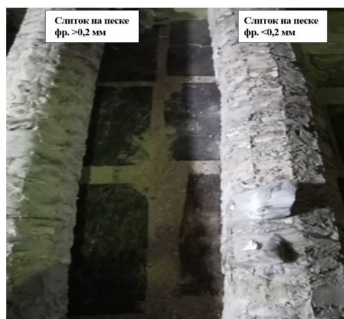
Рис. 2. Фото продукта плавки кварцевого песка Раменского месторождения разных фракций в виде слитка
