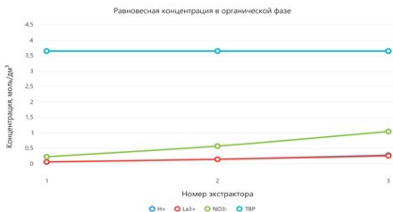
Рис. 3. Распределение концентраций базовых химических форм в органической фазе
