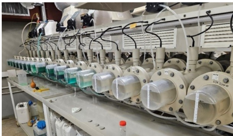
Рис. 1. Экстракционная установка для конверсии хлорид-сульфатного никелевого раствора
