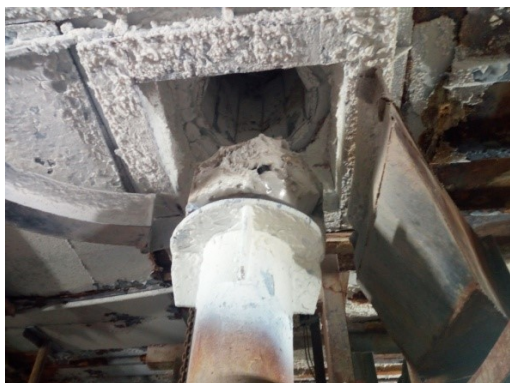
Рис. 1. Механизм для вытягивания слитка кварцевого стекла с «затравкой»
