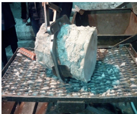
Рис. 4. Часть слитка кварцевого стекла
