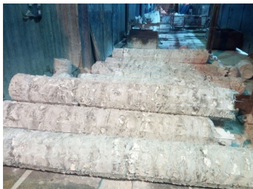
Рис. 3. Готовые слитки кварцевого стекла
