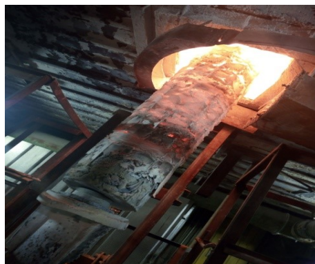
Рис. 2. Этап выработки кварцевого стекла, фото плазмотрона снизу
