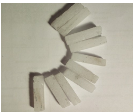
Рис. 6. Образцы кварцевого стекла для измерения термического коэффициента линейного расширения
