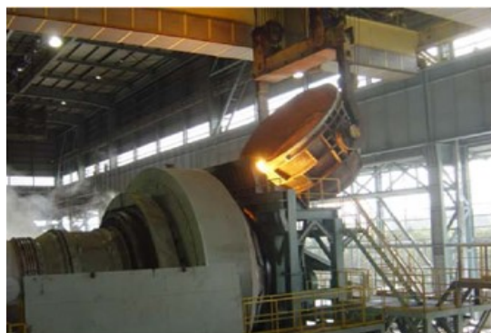
Рис. 2. Подача расплава в установку для переработки конвертерных шлаков в жидком состоянии на комбинате «Баосталь»
