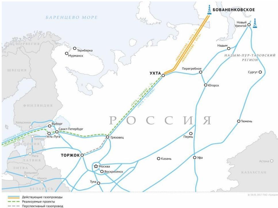
Рис. 3.6. Схема газопроводов «Бованенково-Ухта», «Бованенково-Ухта 2», «Ухта-Торжок», «Ухта-Торжок 2», «Грязовец-Выборг» и «Грязовец-Усть-Луга» [18]
