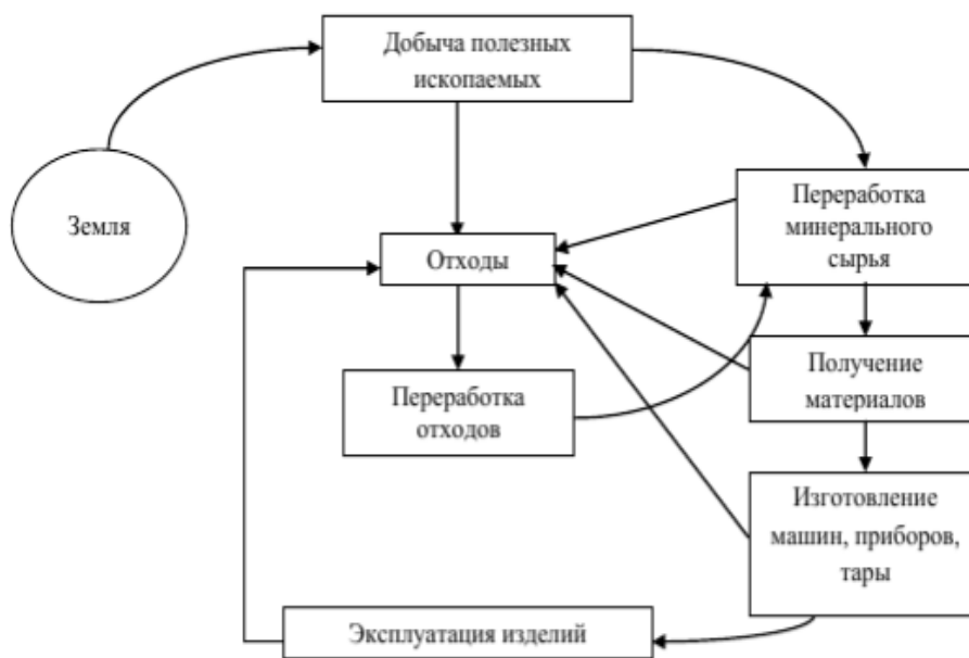
Рис. 5.4. Незамкнутый цикл полного использования материалов. Источник: [Верхотуров, 2002]
