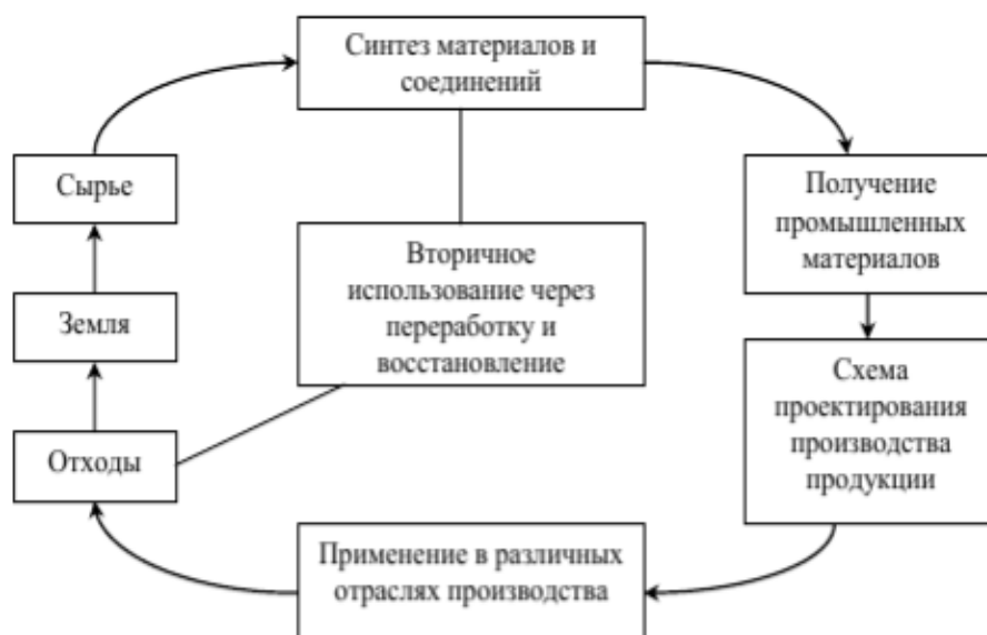
Рис. 5.3. Цикл полного использования материалов. Источник: [Materials Week..., 1994]
