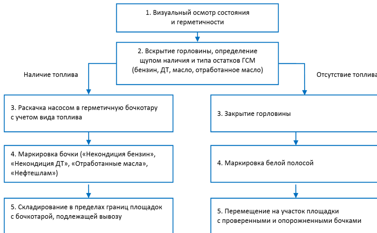
Рис. 3. Алгоритм подготовки к погрузочно-разгрузочным операциям железных бочек для хранения ГСМ.
