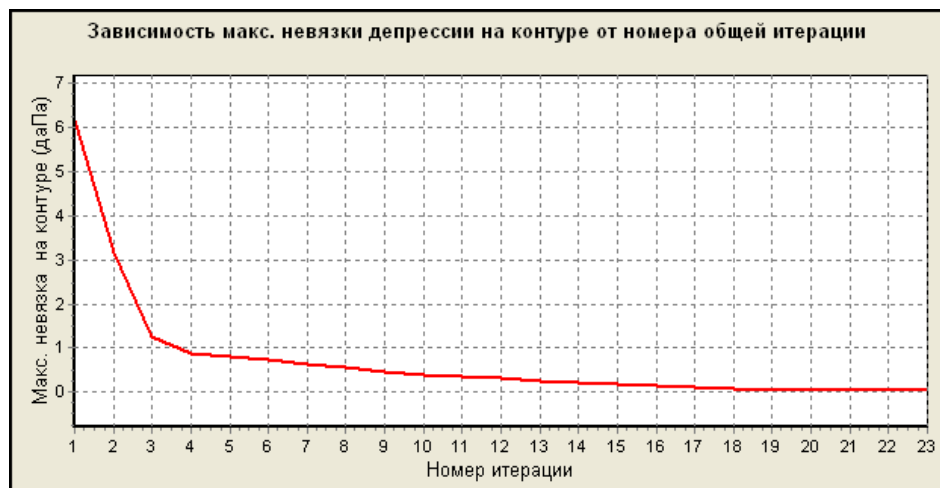
Рис. 1.21. График зависимости невязки депрессии на контуре от номера итерации
