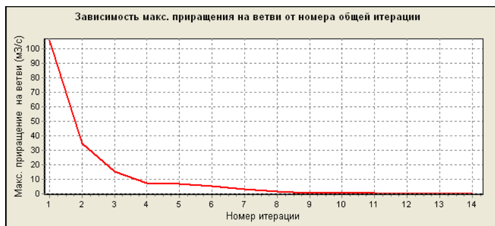
Рис. 1.9. График зависимости максимального приращения на ветви от номера общей итерации при расчете по усовершенствованному методу
