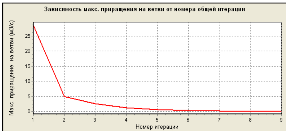
Рис. 1.14. График зависимости максимальной невязки на ветви от номера итерации
