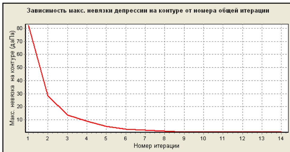
Рис. 1.8. График зависимости максимальной невязки на контуре от номера общей итерации при расчете по усовершенствованному методу
