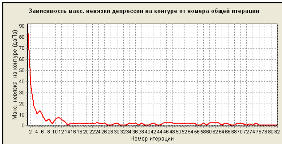
Рис. 1.4. График зависимости максимальной невязки депрессии на контуре от номера общей итерации
