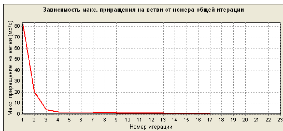
Рис. 1.22. График зависимости приращения расхода воздуха на ветви от номера итерации
