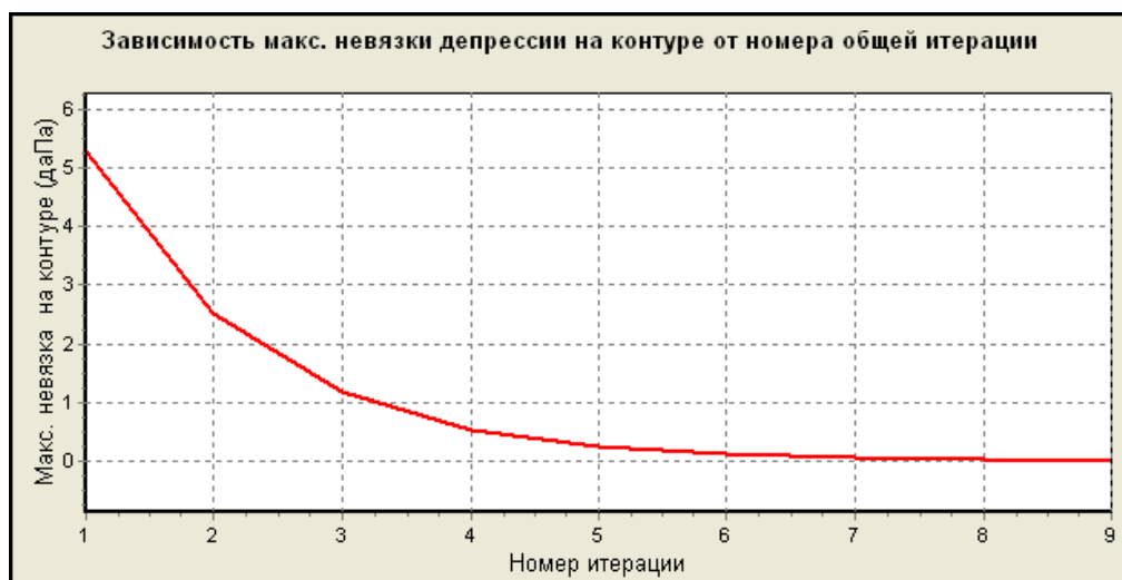
Рис. 1.13. График зависимости максимальной невязки депрессии на контуре от номера итерации
