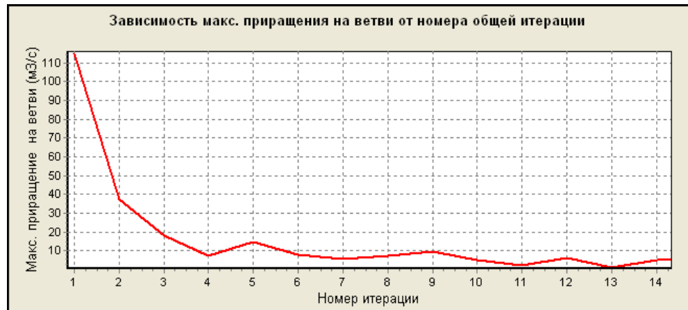
Рис. 1.7. График зависимости максимального приращения на ветви от номера общей итерации (до 14-й итерации)
