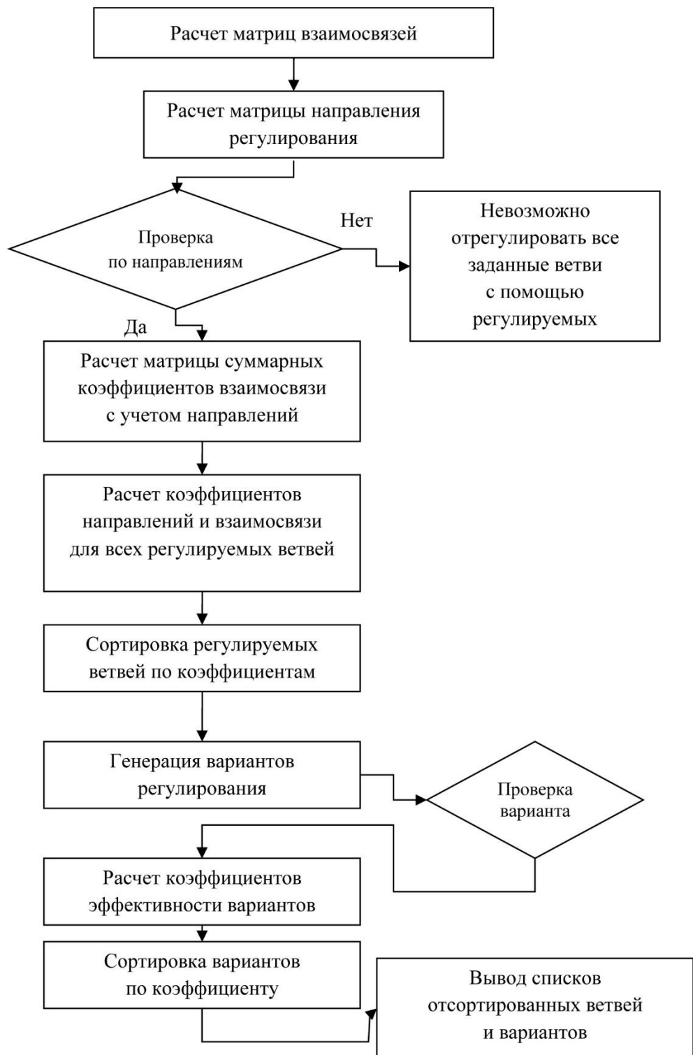
Рис. 1.2. Блок-схема алгоритма анализа взаимосвязи параметров вентиляционной сети
