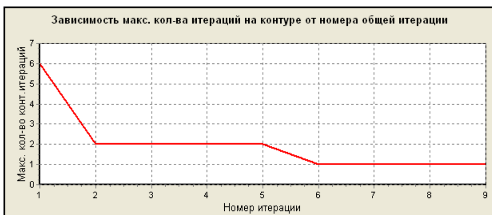
Рис. 1.15. График зависимости максимального количества вложенных итераций от номера общей итерации
