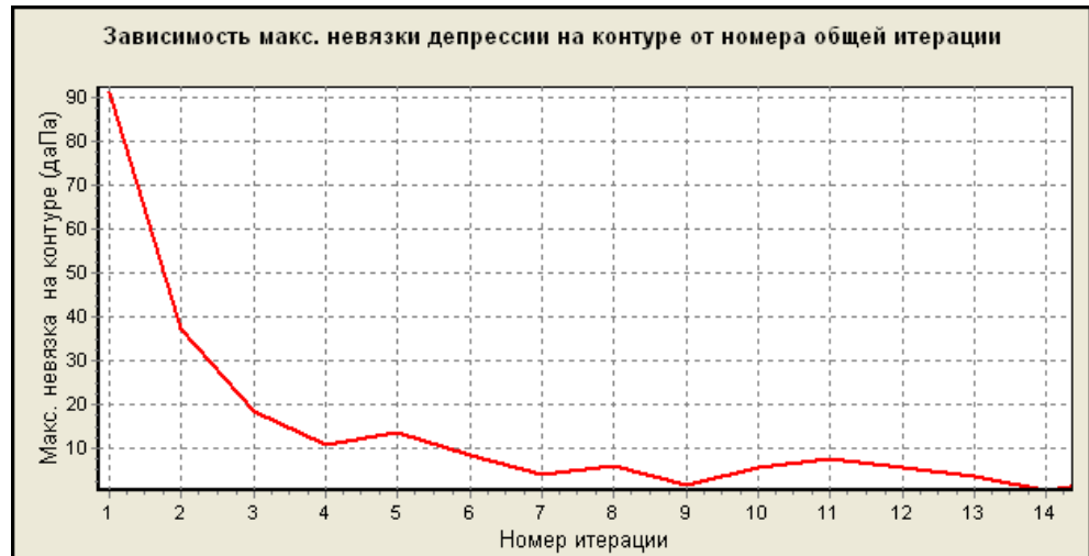
Рис. 1.6. График зависимости максимальной невязки на контуре от номера общей итерации (до 14-й итерации)
