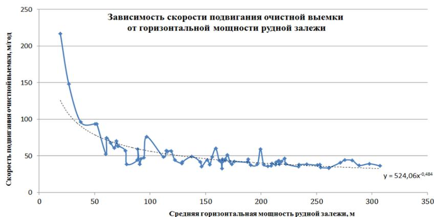
Рис. 2. Зависимость скорости подвигания очистной выемки от горизонтальной мощности рудной залежи при системе разработки с подэтажным обрушением и торцевым выпуском руды со штрековой подготовкой шахтного поля
