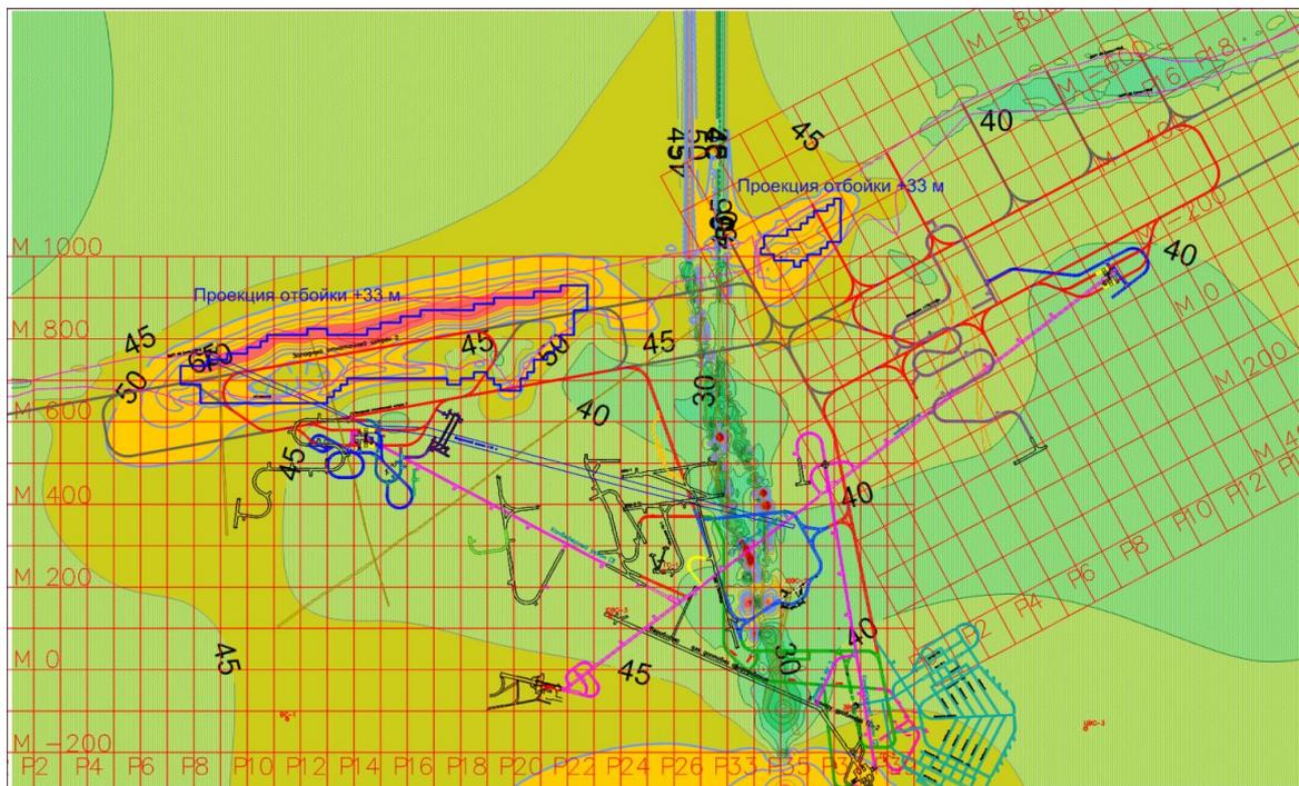
Рис. 4. Распределение  $\sigma_{\max}$  на гор. +10 м для варианта с двумя разрезами на Кукисвумчоррском и Юкспорском месторождениях
