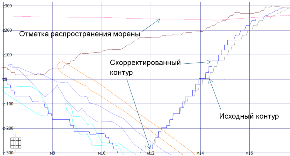
Рисунок 2 – Исходный и скорректированный контура борта карьера по профилю № 9
