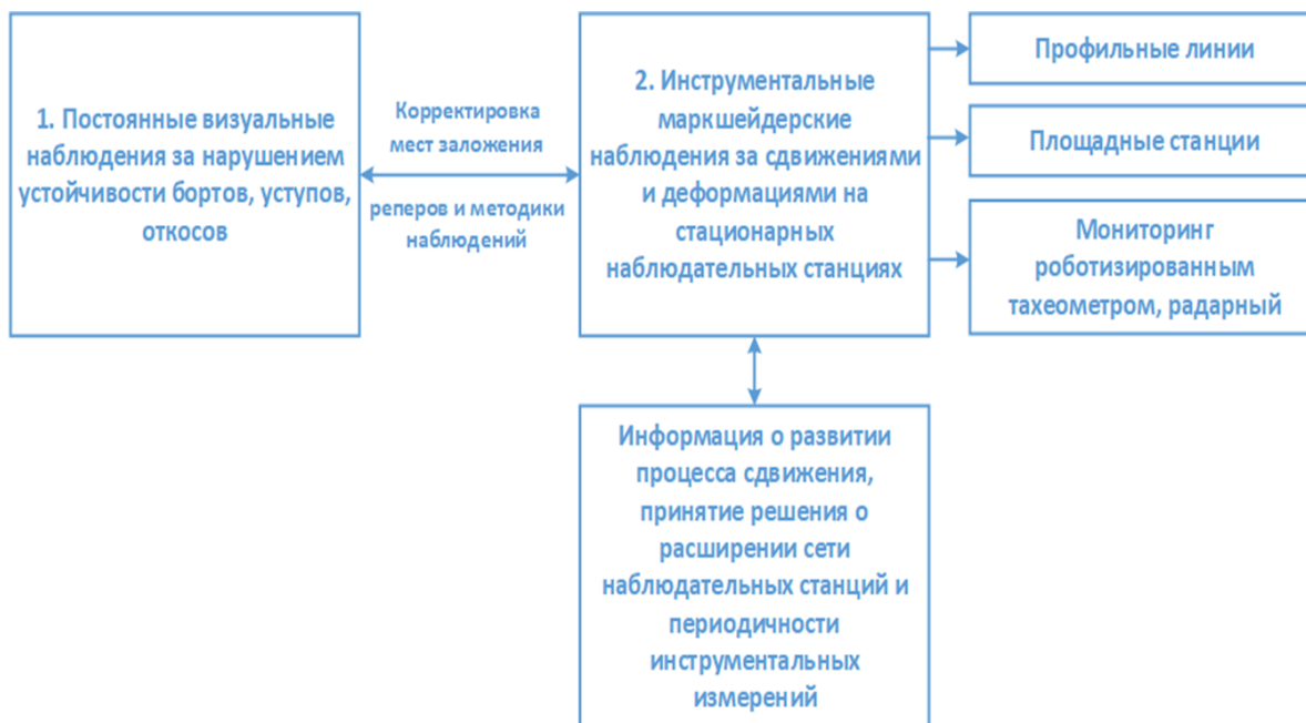
Рисунок 1 – Схема поэтапного формирования системы деформационного мониторинга
