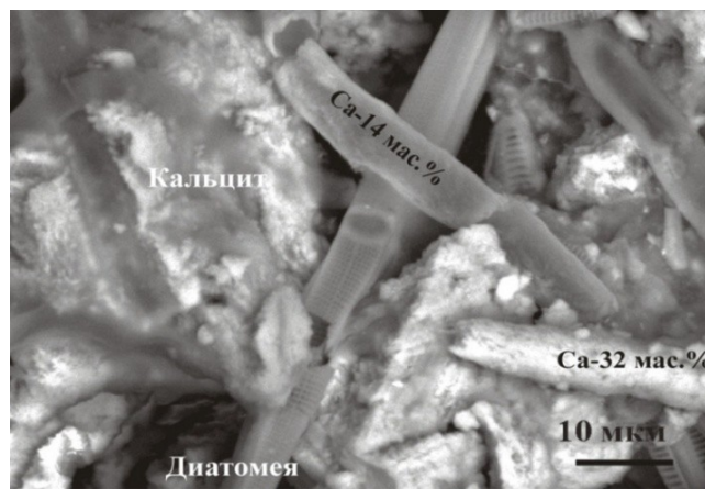
Рис. 5. Карбонатные псевдоморфозы по нитям цианобактерий
