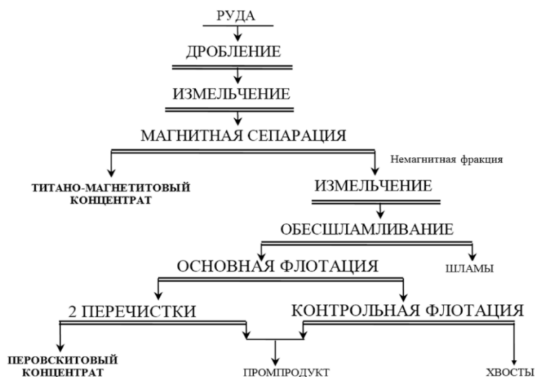
Рис. 1. Принципиальная схема флотации перовскитовой руды
