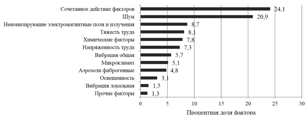
Рис. 1. Структура вредных производственных факторов на предприятиях в Арктике
