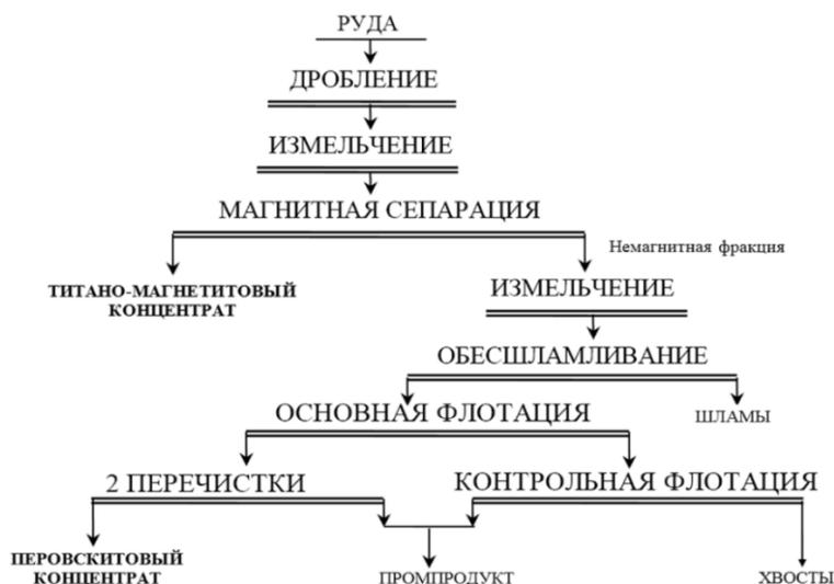
Рис. 1. Принципиальная схема флотации перовскитовой руды
