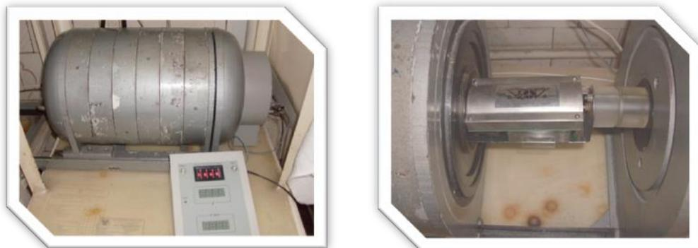
Рис. 3.2. Внешний вид радиометра УМФ-1500Д и счетной камеры
