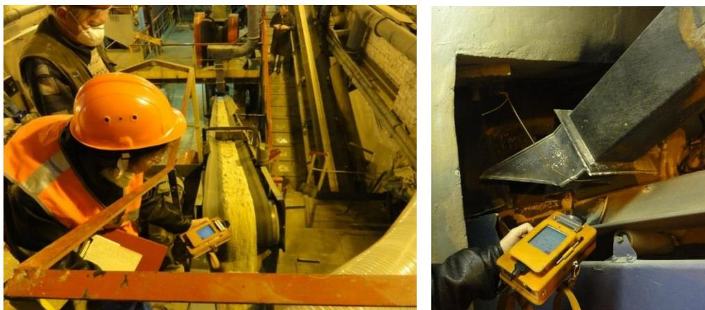
Рис. 4.11. Отбор проб воздуха в производственных условиях: флотации (слева) и дробления редкометаллической руды (справа)
