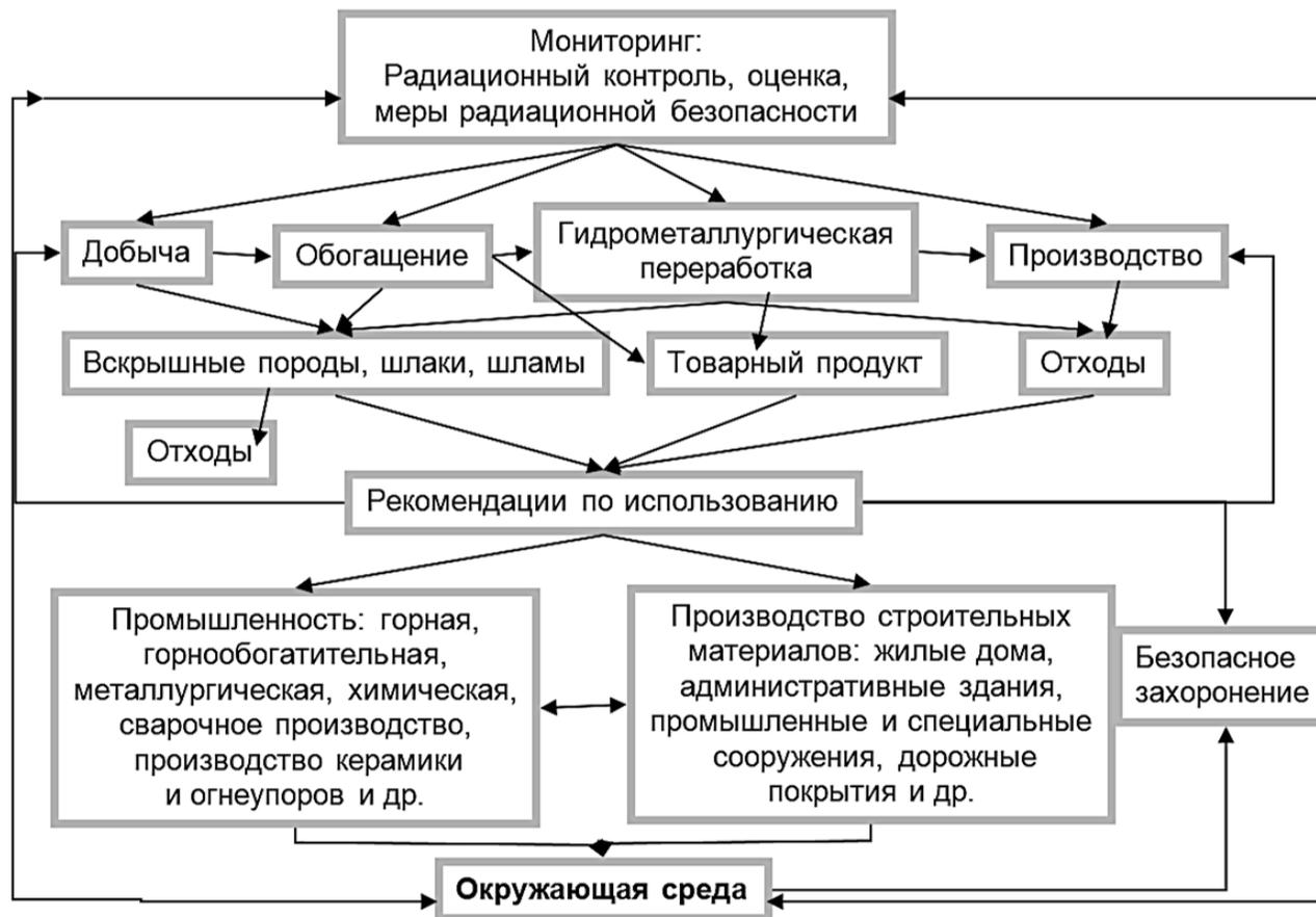
Рис. 4.16. Схема радиационного мониторинга и реабилитации в системе производство-окружающая среда.
