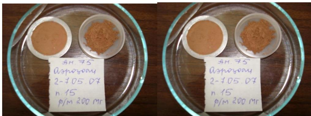
Рис. 3.7. Счетные образцы атмосферных аэрозолей (слева) и осадков (справа) для определения суммарной удельной альфа- и бета-активности
