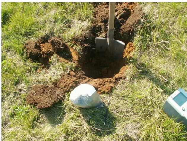
Рис. 3.12. Отбор пробы почвы в полевых условиях
