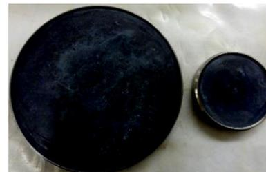
Измерительные тарелки из свинца Ø 10 см и 5 см для порошковых проб
