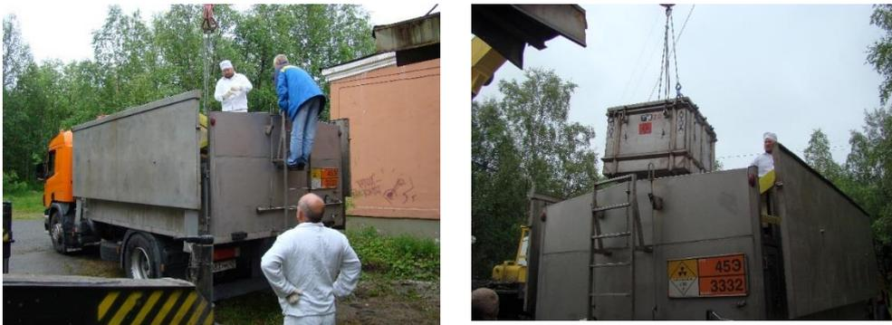
Рис. 2.20. Погрузка свинцовых контейнеров с РАО в спецмашину для транспортировки
