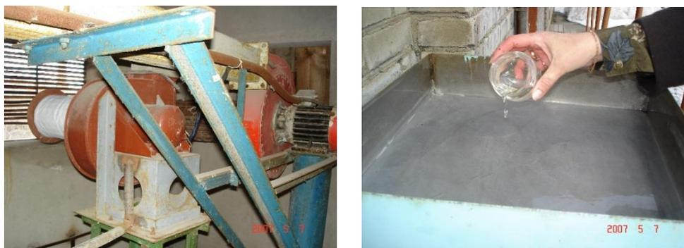
Рис. 3.6. Установки Апатитского Радиологического отдела Роспотребнадзора для сбора атмосферных аэрозолей (слева) и осадков (справа)
