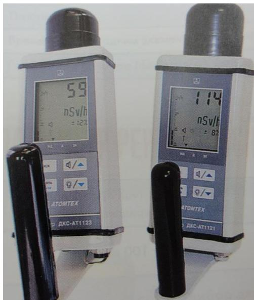
Рис. 2.22. Дозиметры ДКС-АТ1121 (слева) и ДКС-АТ-1123 (справа)
