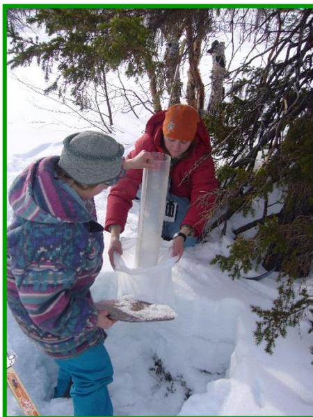
Рис. 3.4. Отбор проб снега специальным пробоотборником
