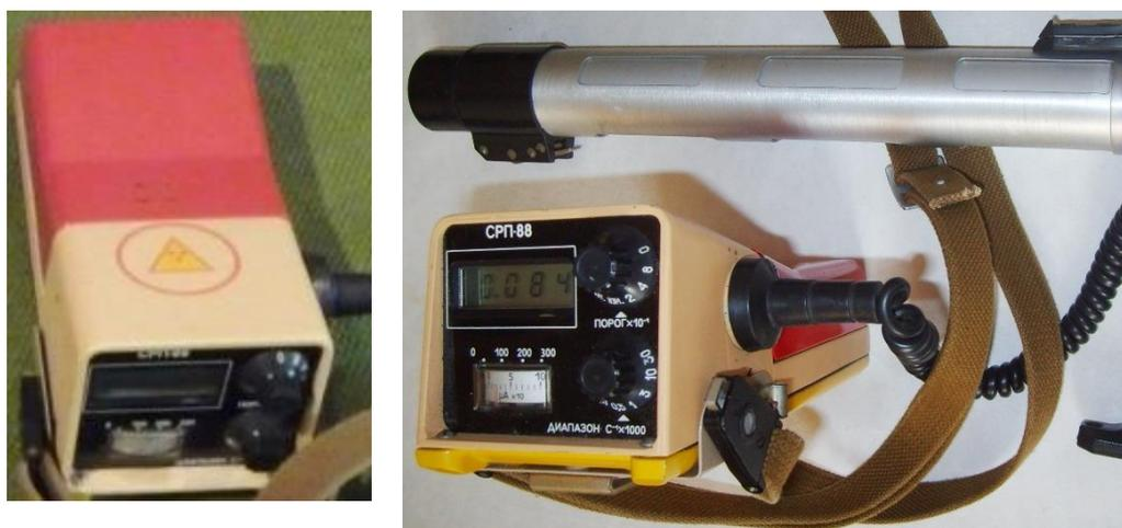
Рис. 4.3. Радиометр СРП-88Н: слева — пульт цифрового измерителя с отсеком для блока питания, справа — пульт с подключенным блоком детектирования
