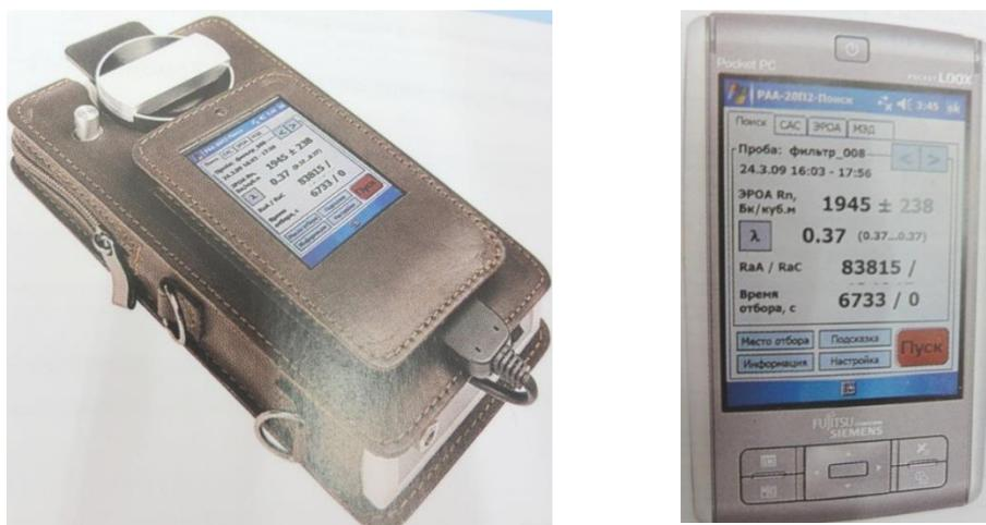
Рис. 4.10. Аэрозольный радиометр РАА-20П-2 «Поиск» со встроенным программным обеспечением (КПК), зарядным устройством и фильтром
