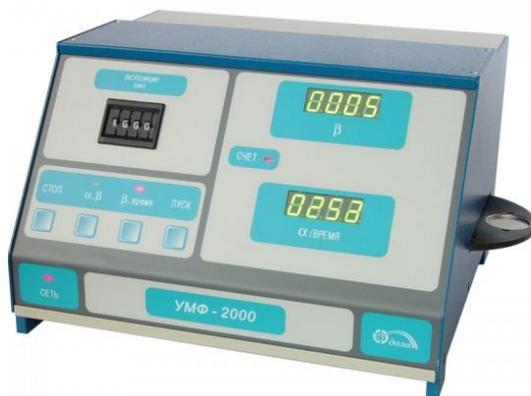
Рис. 3.3. Внешний вид радиометра УМФ-2000 для анализа низкоактивных проб по суммарной альфа- и бета-активности
