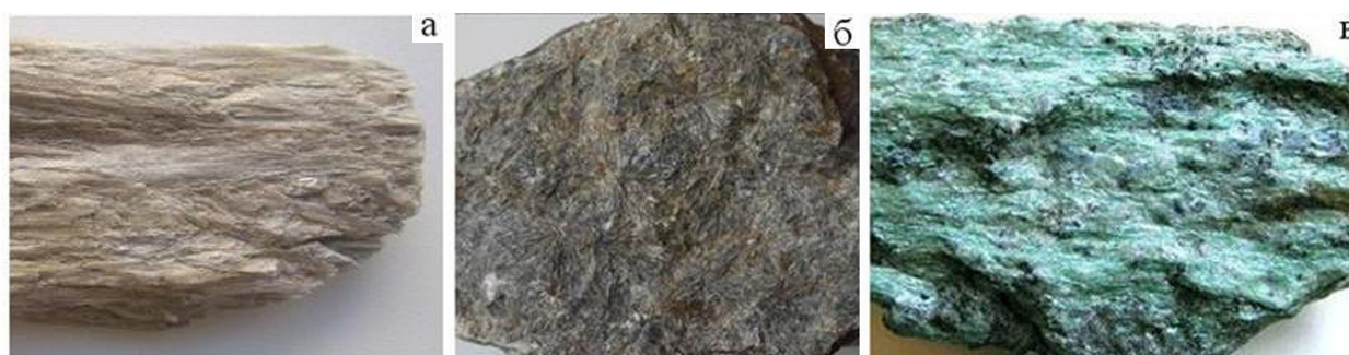
Рис. 1. Различные морфологические типы кианита месторождения Хизоваара. а – серый игольчатый, б – серый радиально-лучистый; в – синий коротко-призматический из фукситовых сланцев.
