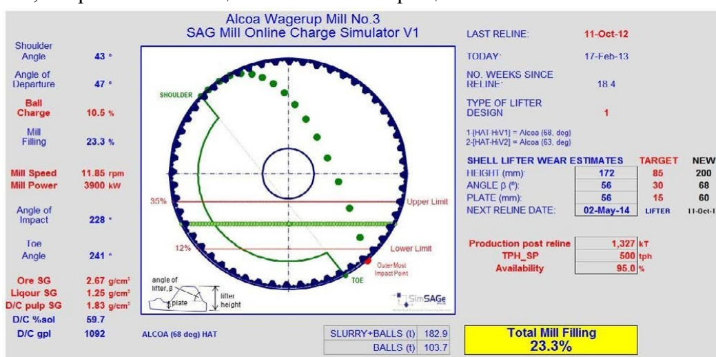
Рисунок 7. Пример моделирования мелющей загрузки в программе SAGMillOnlineChargeSimulator
