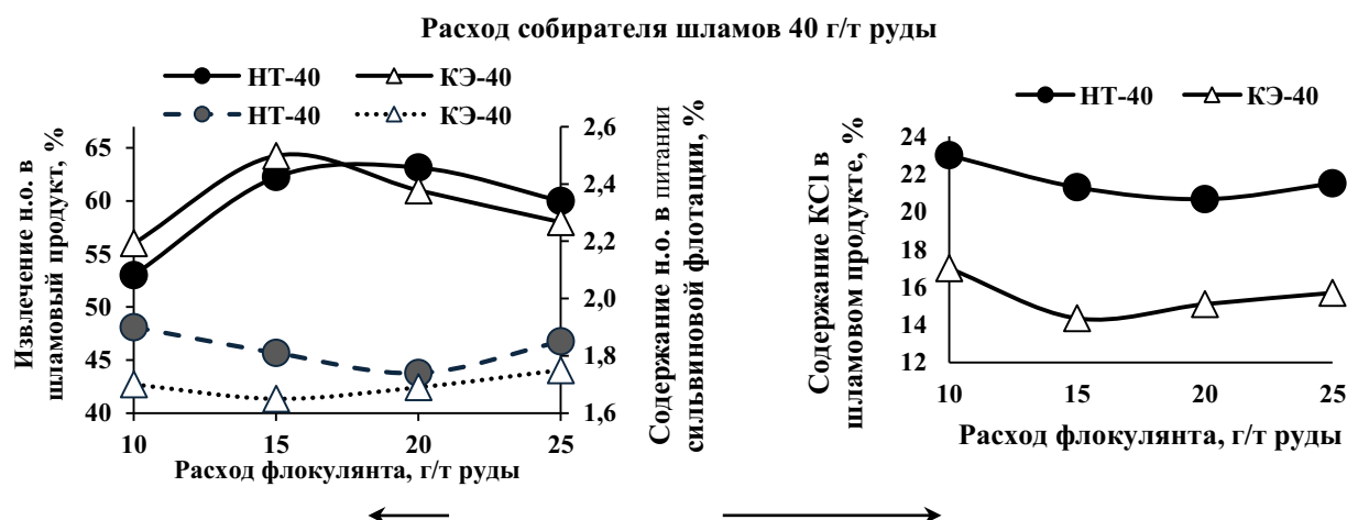
Рисунок 1. Показатели проведения обесшламливания руды при расходе в качестве собирателя шламов оксиэтилированного амина (НТ-40) и карданола (КЭ-40).
