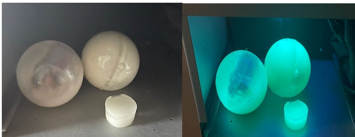
Рисунок. Внешний вид образца люминофорсодержащего имитатора алмазов в дневном (а) и ультрафиолетовом (б) свете
