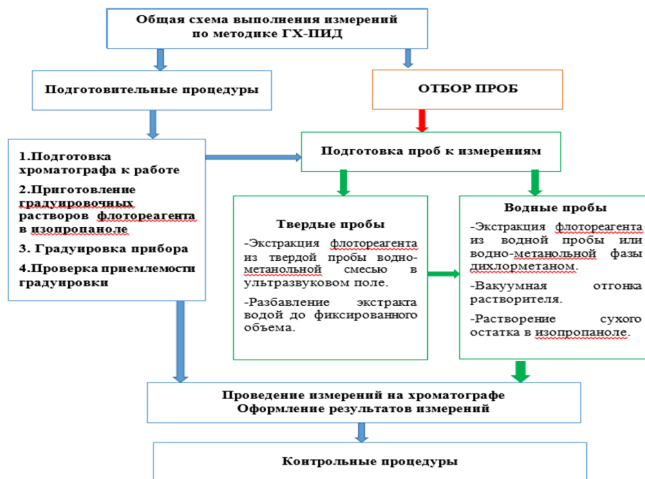
Рисунок. Схема выполнения измерений методом ГХ-ПИД
