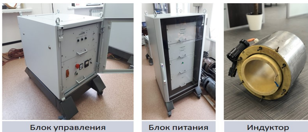
Рисунок. Внешний вид оборудования для магнитно-импульсной обработки руды
