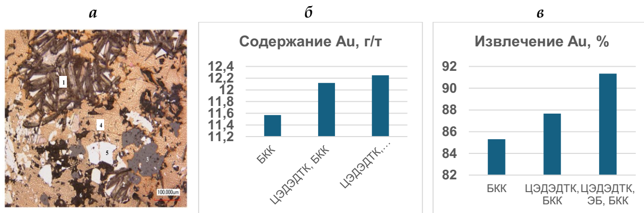
Рисунок. Изображение поверхности рудного аншлифа Малиновского после контакта с раствором МДТК (KEYENCE VK-9700) (а) и результаты флотации руды при тестировании нового реагентного режима (б, в):
