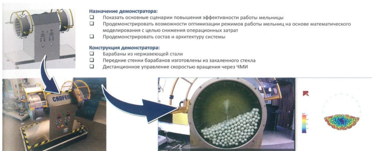
Рисунок 4. Демонстратор цифрового двойника барабанной мельницы (АО «Моделирование и Цифровые Двойники», Россия)
