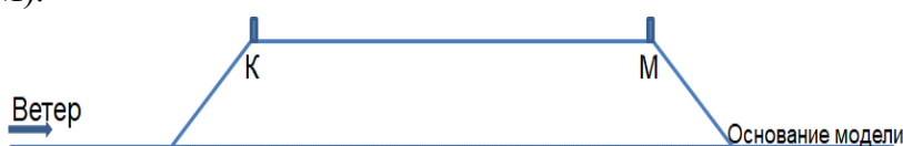
Рисунок. Размещение ограждений (барьеров) на поверхности пыления
