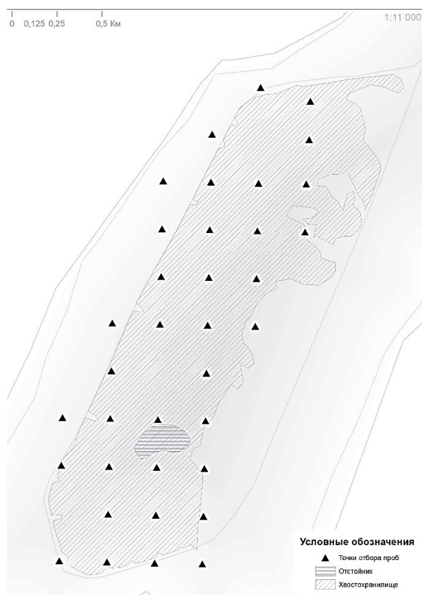
Рисунок. Схема отбора проб хвостов обогащения
