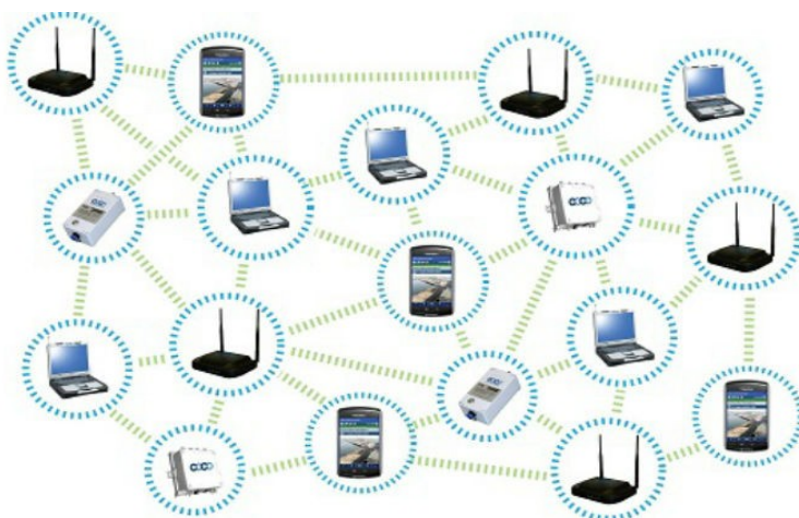
Соединения между узлами беспроводной многошаговой сети
