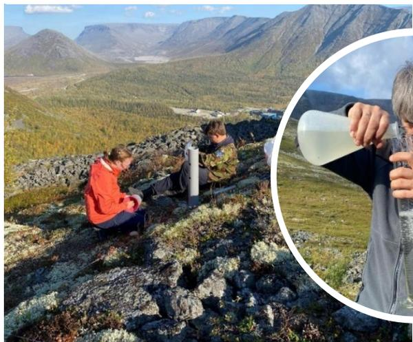
▼ Экспедиция ПАБСИ КНЦ РАН - Давыдов Д.А. Измерение количества осадков из лизиметров - специальных приборов для сбора почвенных вод
