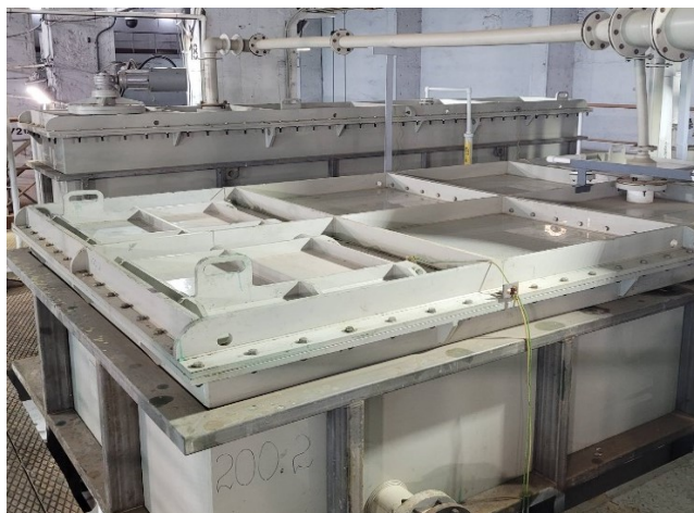
Рис. 3. Полипропиленовый экстрактор производства «Русредмет» во второй нитке экстракции кобальта
