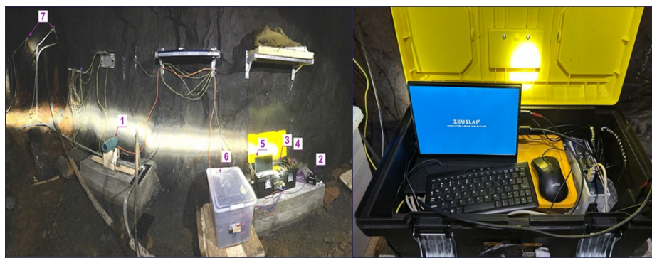
Рисунок 1 – Общий вид подземного пункта (слева) и системы регистрации (справа) (1 – расходомер EM470; 2 – акселерометр RefTek 147-01/3; 3 – аналогово-цифровой преобразователь L-Card E14-140M; 4 – промышленный компьютер ICO300E; 5 – портативный монитор; 6 – АКБ; 7 – субгоризонтальные скважины
