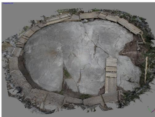
Рис. 4. 3D-модель скалы Каменный 7 под защитным куполом (общий вид) реконструированная с помощью технологии 3D-фотограмметрии
