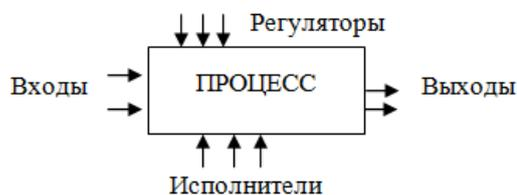
Рис. 3 Общая схема процесса (в соответствии с нотацией IDEF[4])
