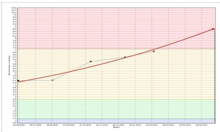
Рис. 4. Тренд изменения вибрации машины
