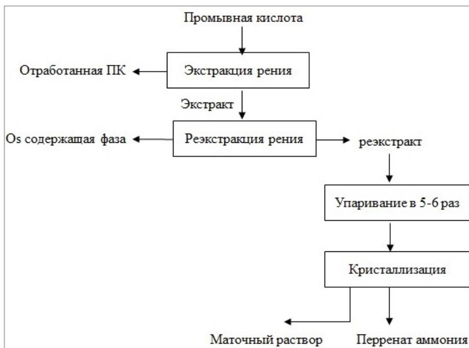
Рис. 30. Экстракционная технология переработки промывной кислоты Жесказганского медного завода
