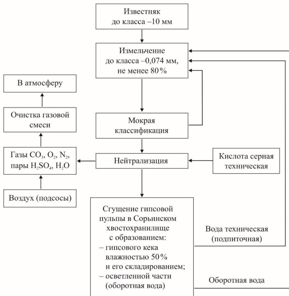
Рис. 27. Блок-схема нейтрализации серной кислоты природным известняком на АО «Святогор»
