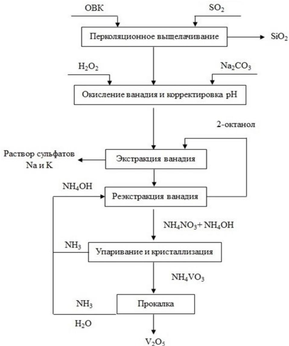
Рис. 45. Принципиальная технологическая схема получения чистого пентаоксида ванадия из отработанных ванадиевых катализаторов
