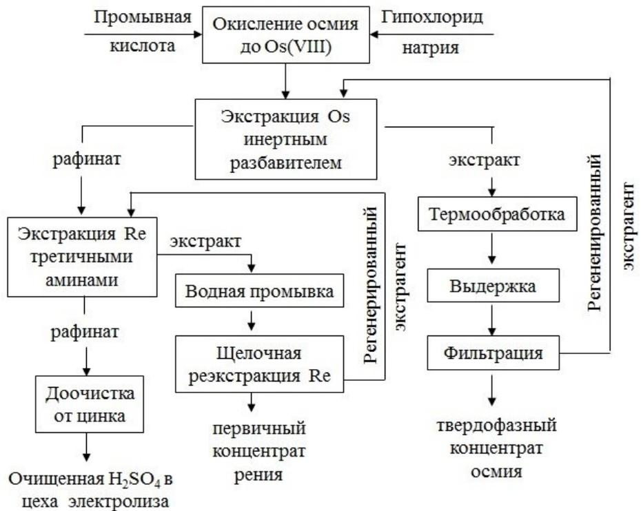
Рис. 36. Принципиальная схема избирательного извлечения осмия и рения из промывной кислоты
