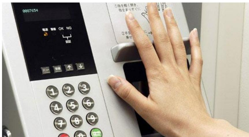
*Рис. 1. Биометрический считыватель отпечатка ладони*
