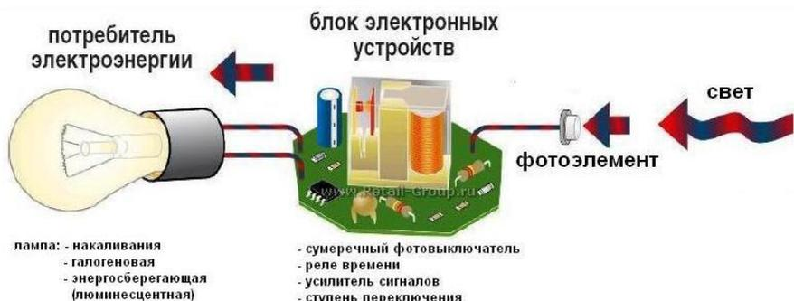
*Рис. 1. Принцип работы датчика освещённости*
