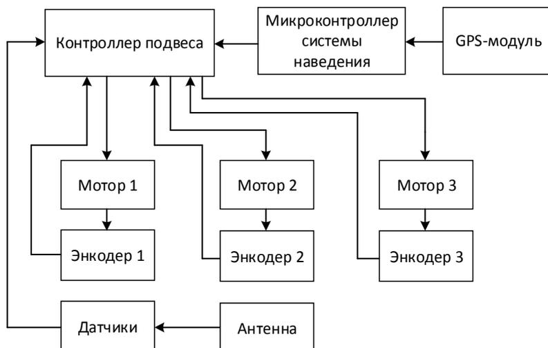
Рис. 3. Структурная схема системы стабилизации положения бортовой антенны
