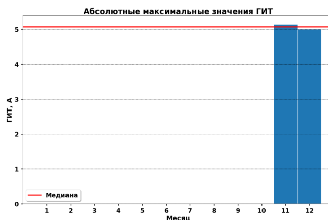
Рис. 16. Результаты классификации токов в нейтрали автотрансформатора на подстанции LKH за 2019 г.
