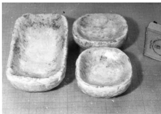
Рис. 5.7. Опытные образцы кюветы объемом 100 \text{ см}^3 и тиглей объемом 30 \text{ см}^3 из кварцевой керамики с покрытием из \text{Nb}_2\text{O}_5
