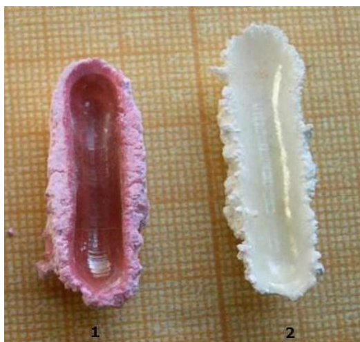
Рис. 1.5. Лодочки для проведения зонной плавки: 1 — \text{Er}_2\text{O}_3 ; 2 — \text{Y}_2\text{O}_3
