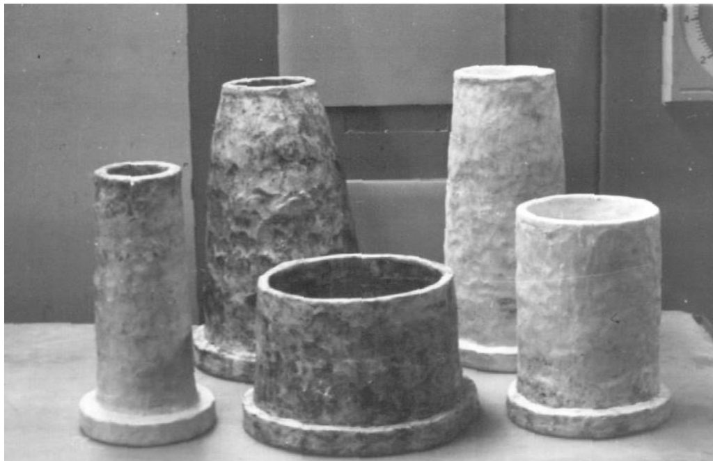
Рис 5.13. Опытные образцы царг, изготовленных из слоистой керамики, с фрагментированной кварцевой основой, организованной макроструктурой и двухсторонним покрытием из \text{Nb}_2\text{O}_5
