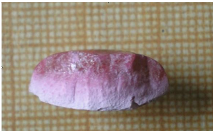
Рис. 3.4. Слиток Er_2O_3 , полученный по методу наплавления постаменту
