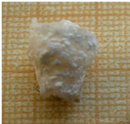
Рис. 3.3. Слиток Y_2O_3 , полученный заплавлением предварительно сформированного тигля
