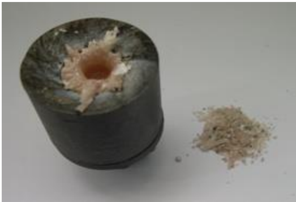
Рис. 2.16. Тигель после плавления и гранулирования материала в системе \text{ZrO}_2 - \text{HfO}_2 - \text{Y}_2\text{O}_3
