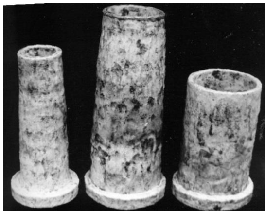
Рис. 5.20. Керамические детали шахты провальной печи
