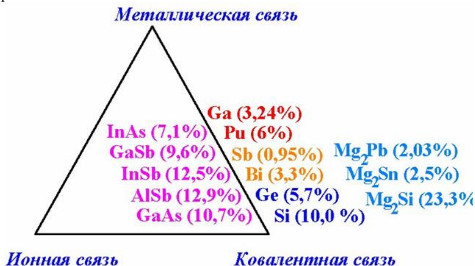
Рис. 3.13. Величина объемного эффекта кристаллизации и распределение веществ, расширяющихся при кристаллизации, по типу химической связи
