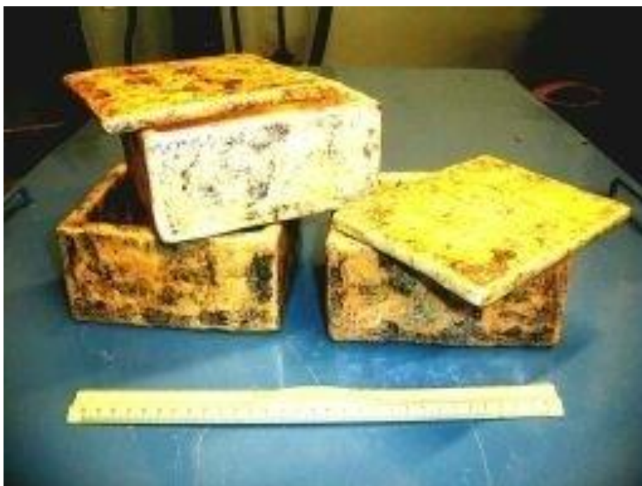
Рис. 5.10. Партия слоистых керамических контейнеров из слоистой керамики объемом один литр с крышками
