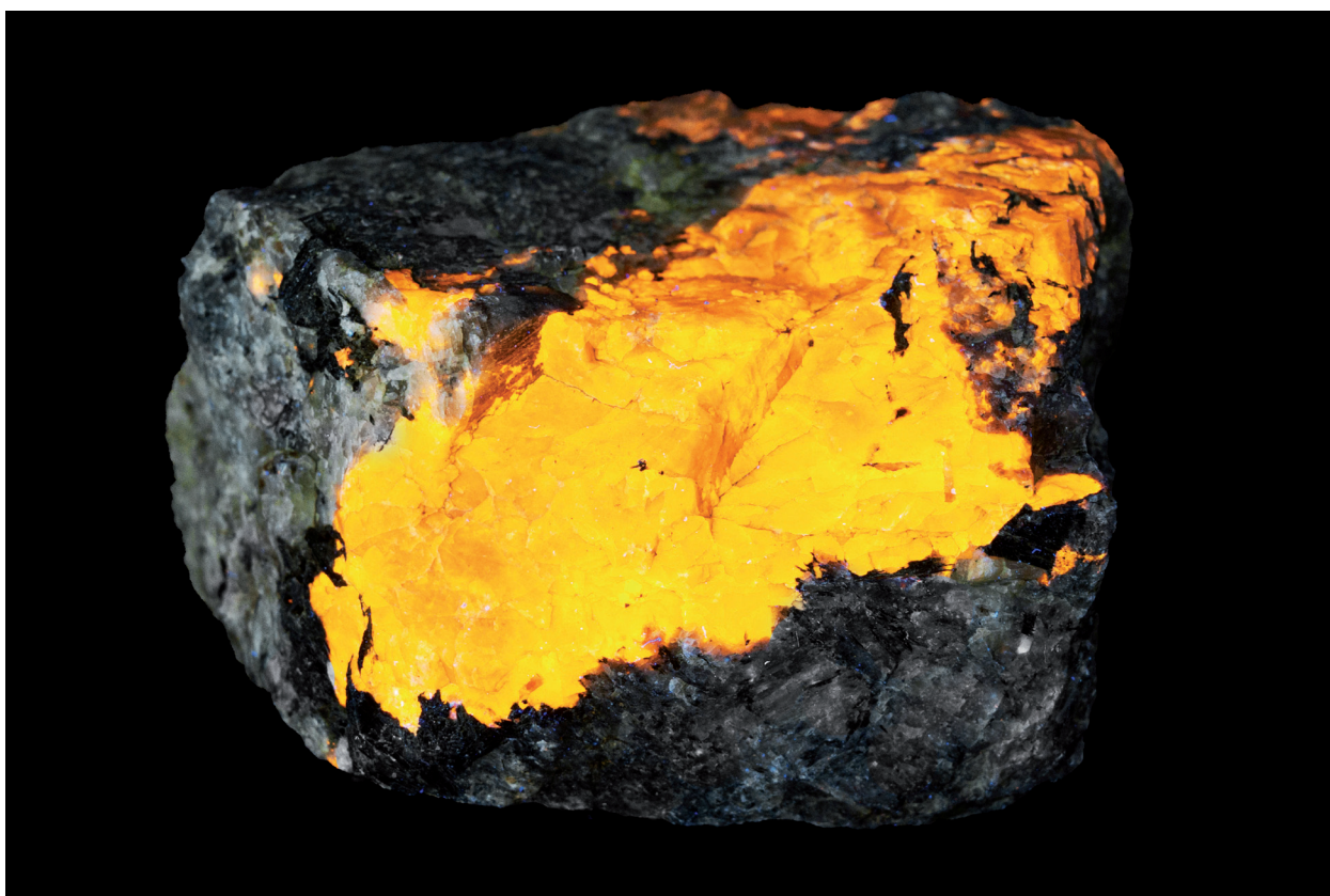
Люминесценция содалита при облучении ультрафиолетом с длиной волны 365 нм Luminescence of sodalite under UV irradiation with 365 nm wavelength
