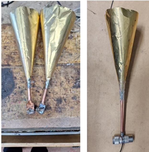
Рис. 1. Рупоры с медными трубками
