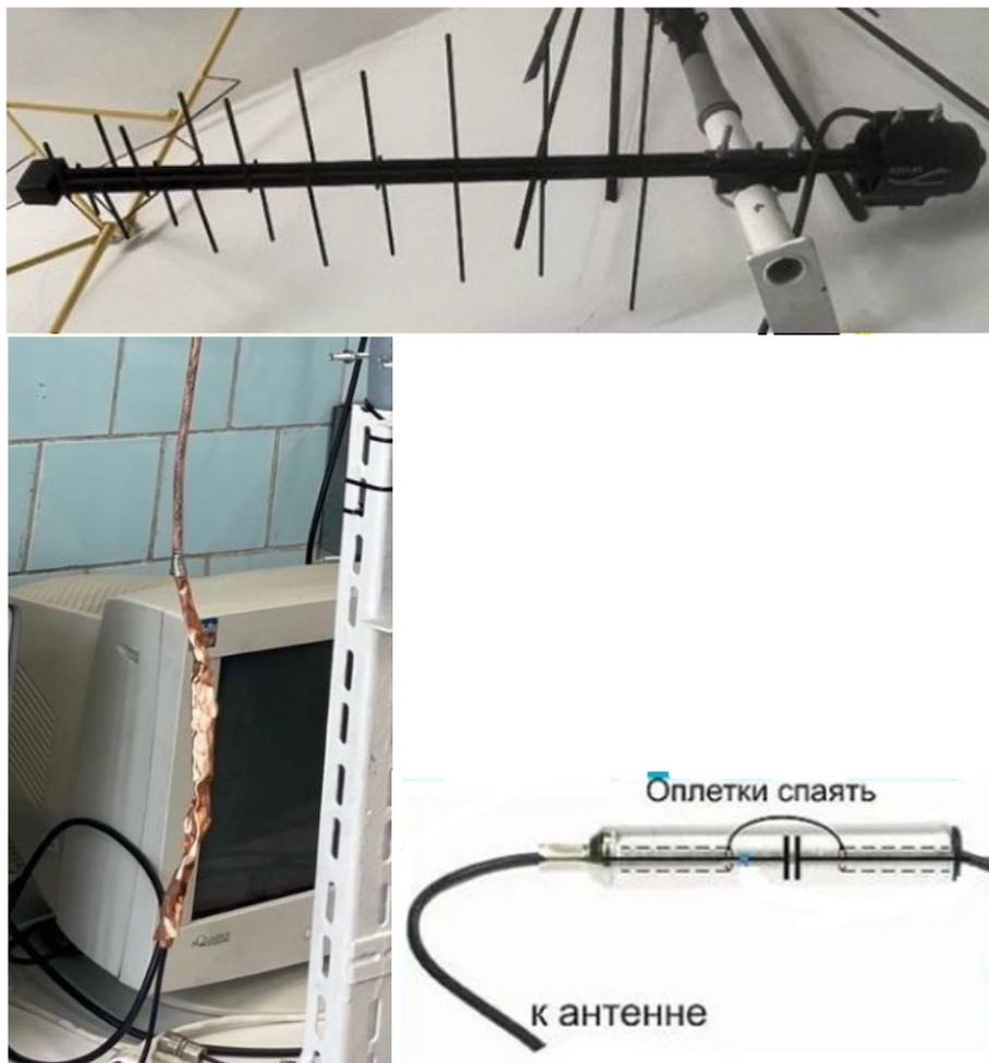
Рис. 2. Введение конденсатора при разрыве оплетки кабеля телевизионной антенны
