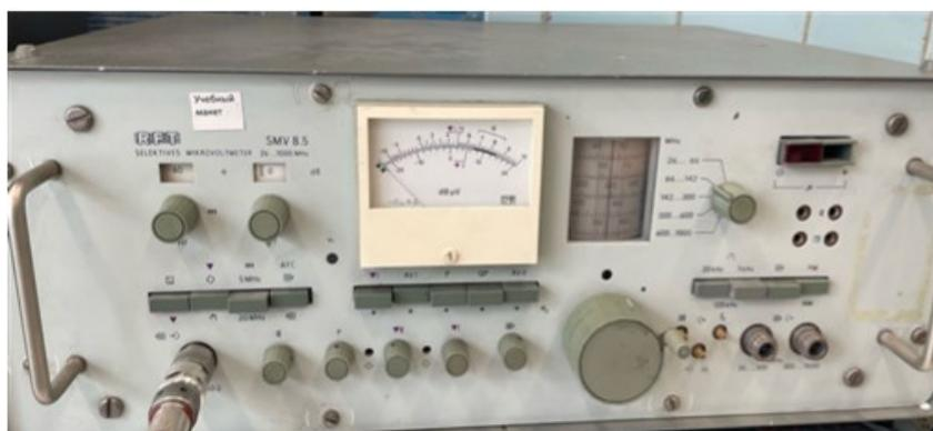
Рис. 3. Селективный микровольтметр
