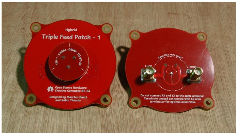
Рис. 1. Фотография гибридного варианта TFP [Triple Feed Patch antenna, 2024]
