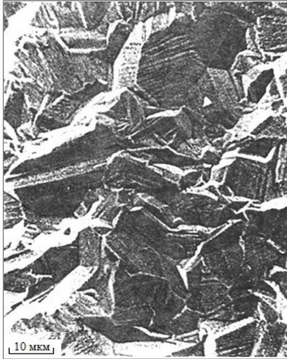
**Рис. 7.13.** Морфология поверхности гафниевого покрытия в расплаве  $\text{NaCl-KCl-HfCl}_4$  (10 мас. %).  $T$  — 1023 К;  $I_k$  — 0,03  $\text{A}/\text{cm}^2$ ,  $t_{\text{электр}}$  — 4 часа, толщина покрытия — 135 мкм
