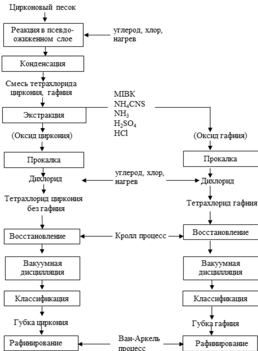
Рис. 1.1. Технологические схемы извлечения гафния и циркония из цирконового песка
