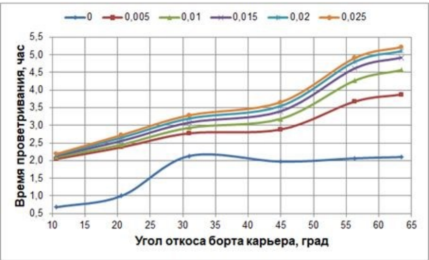
Рис. 6. Время проветривания карьера при вариации угла откоса борта карьера и параметра фоновой стратификации Fig. 6. The ventilation time of the quarry with variations in the slope angle of the side of the quarry and the parameter of background stratification
