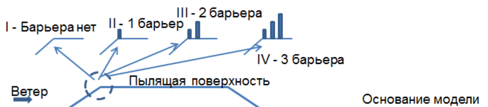
Рис. 1. Варианты искусственных барьеров на пылящей поверхности Fig. 1. Variants of artificial barriers on a dusty surface
