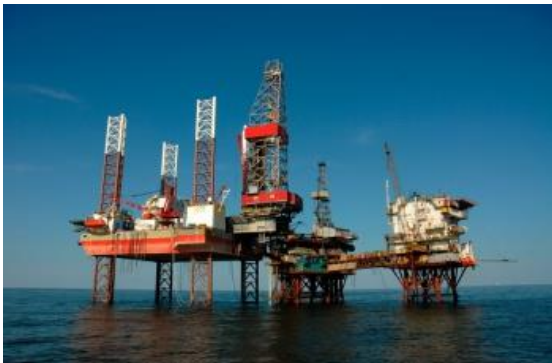
Рис. 3.1 GSP Jupiter - буровая установка для геологоразведки Долгинского месторождения
