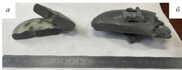
Рис. 1. Внешний вид образцов Dy: а — после процесса восстановления Са-термии; б — после рафинирующего вакуумно-дугового переплава
