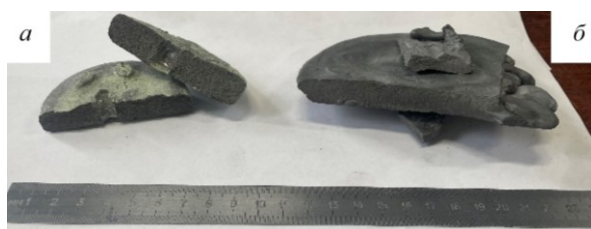
Рис. 1. Внешний вид образцов Dy: а — после процесса восстановления Ca-термией; б — после рафинирующего вакуумно-дугового переплава
