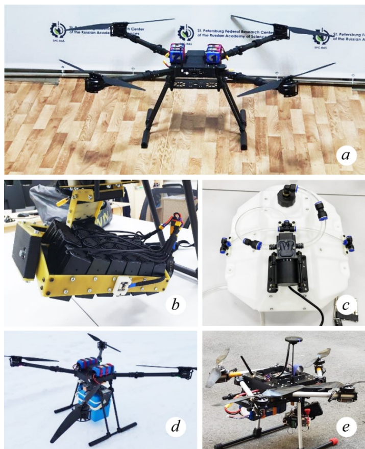
Рис. 1. Серийно выпускаемые БПЛА и навесное оборудование: a — пример БПЛА; b — лазерный блок для стимуляции растений; c — система полива; d — захват и контейнер для транспортировки грузов; e — бортовая видеочкамера
