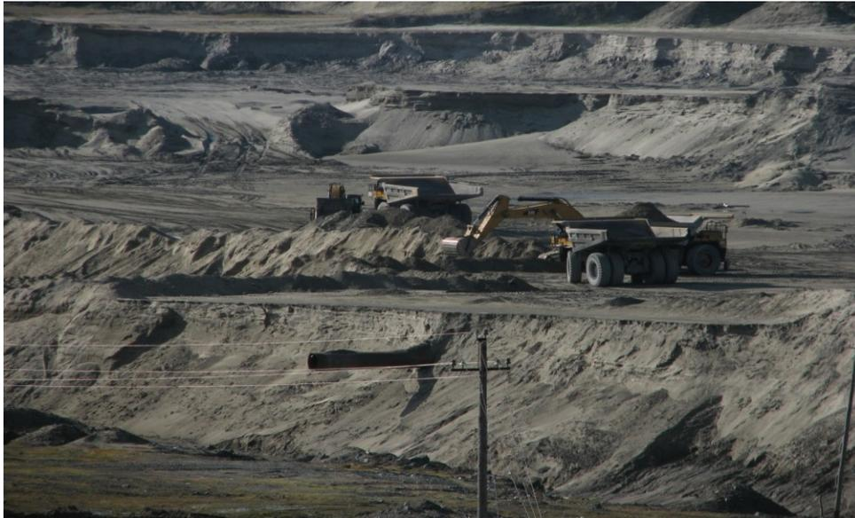
Рис. 2.12. Площадка забоя в карьере на поле 1 хвостохранилища при отработке с помощью большегрузного автотранспорта (90–110 т)
