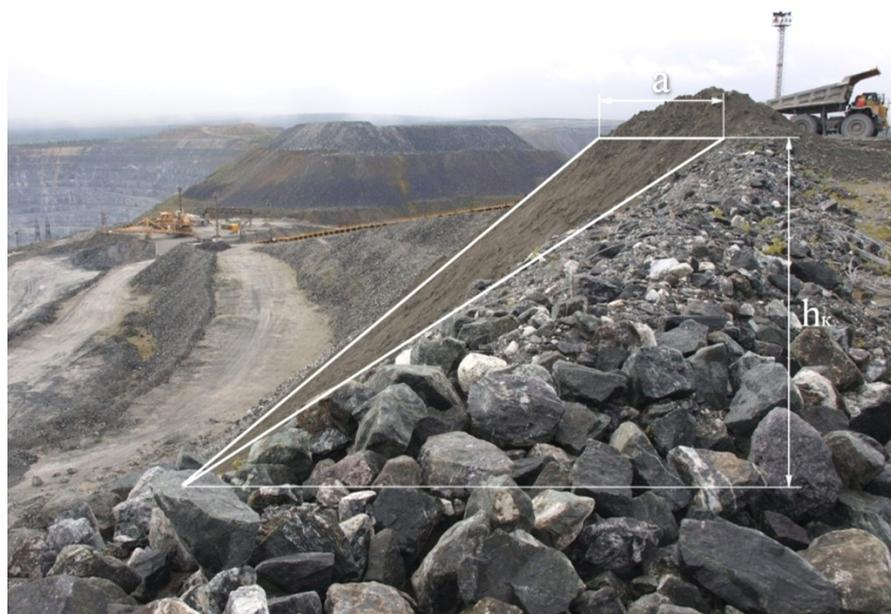
Рис. 3.15. Разгрузка мелкодисперсных отсевов с линии ЦПТ и распределение их на откосе отвала
