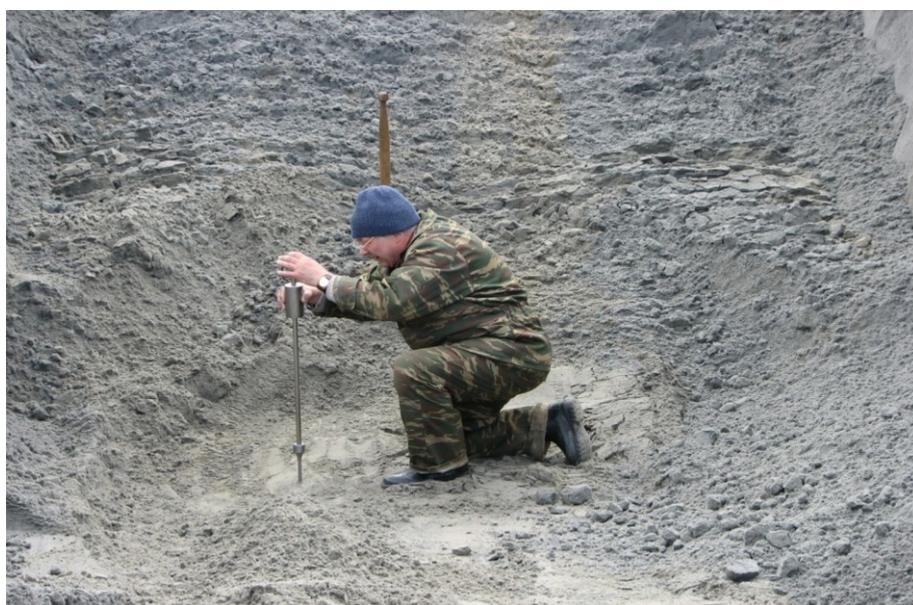
Рис. 2.9. Процесс испытания несущей способности поверхности хвостов прибором У-1 на площадке уступа (-4.5 м от поверхности)
