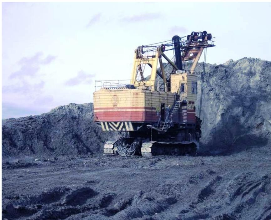
Рис. 2.19. Экскаватор ЭКГ-8И в забое хвостохранилища
