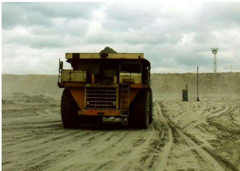
Рис. 2.21. Автосамосвал грузоподъемностью 120 т на хвостохранилище
