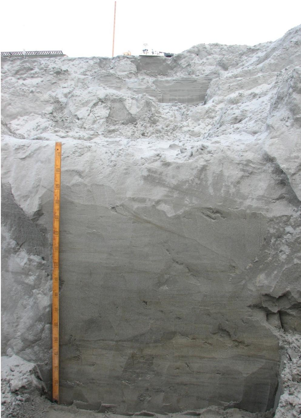
Рис. 2.4. Натурное моделирование площадок и откосов уступов для взятия проб и испытаний материала хвостов
