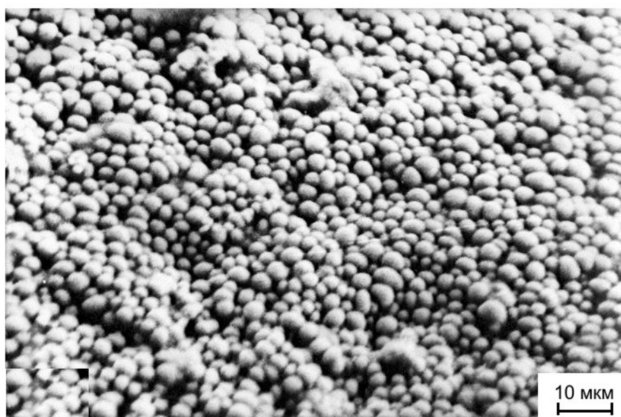
Рис. 7.7. Морфология поверхности подложки из Ст. 3 после выдержки в расплаве \text{NaCl} - \text{KCl} - \text{K}_2\text{NbF}_7 (30 мас. %), равновесном с металлическим ниобием. Время выдержки в расплаве 6 ч, T = 1073 К
