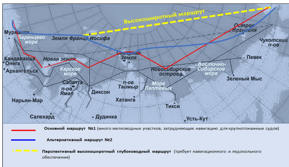
Рис. 8. Действующие и перспективный высокоширотный (глубоководный) маршрут Северного морского пути. Источник: составлено авторами на основе (Афонин, Тезикова, 2017)
