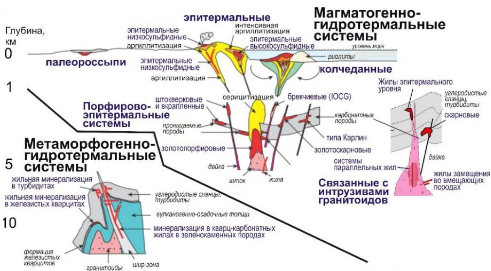
Рис. 4. Схематический разрез, показывающий ключевые геологические характеристики и глубину формирования золоторудных и золотосодержащих месторождений [Models and Exploration..., 2007]
