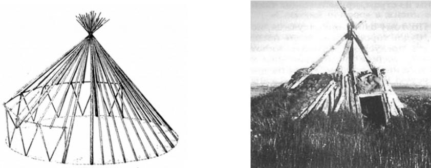
Рис. 4. Схема конструкции и внешний вид землянки юкагиров
