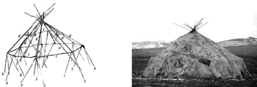
Рис. 3. Схема конструкции и внешний вид яранги
