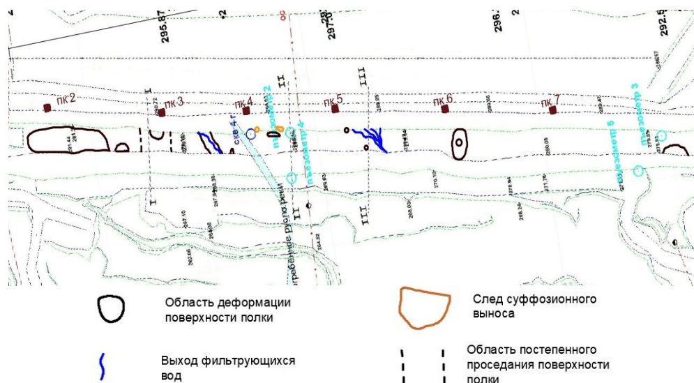
Рис. 3.14. Абрис ограждающей дамбы хвостохранилища горнорудного предприятия
