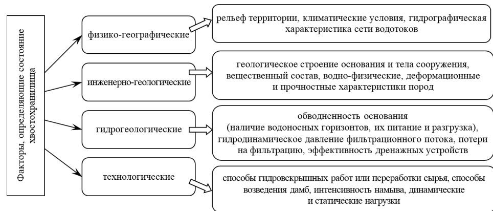
Рис. 1.6. Классификация основных факторов, определяющих состояние хвостохранилищ [13]
