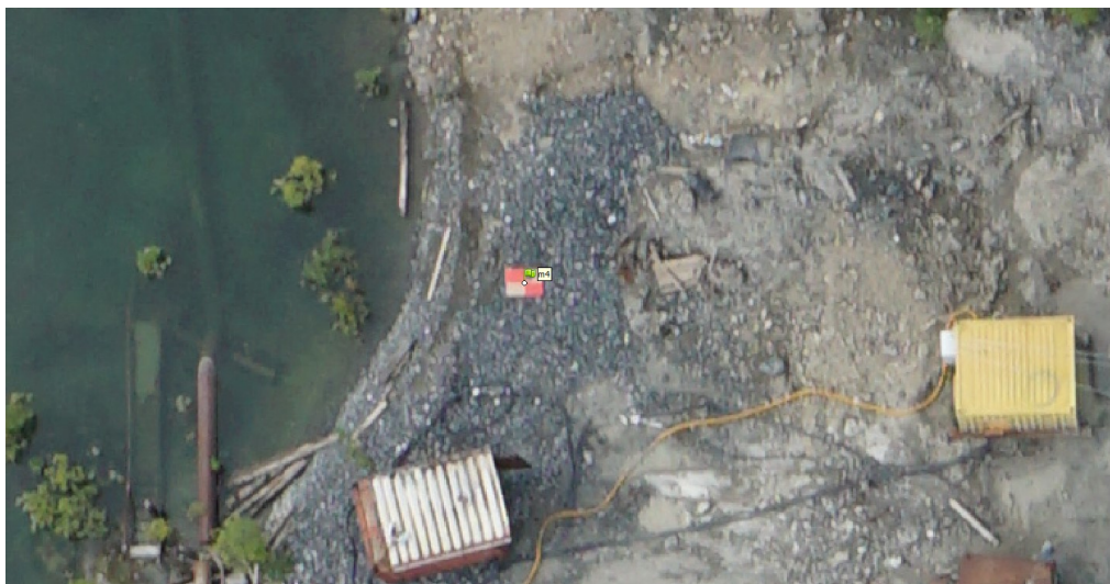
Рис. 3.40. Размещение маркеров на аэрофотоснимке
