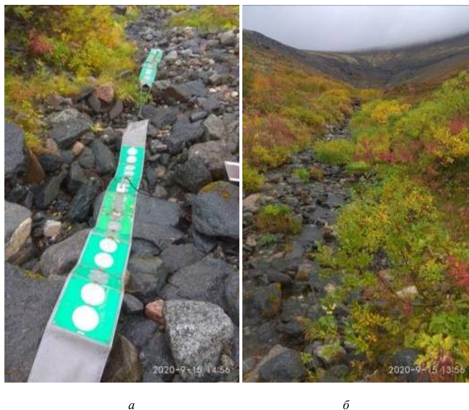
Рис. 4.14. Проведение геофизических исследований на местности: а — георадар «Лоза-1В» (антенна 50 МГц); б — общий вид ручья
