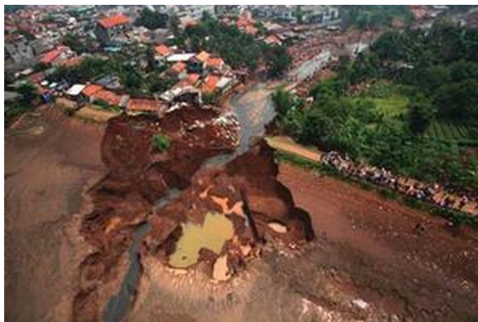
Рис. 5.10. Аэрофотоснимок дамбы Ситу Гинтунг после аварии [275]
