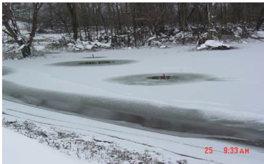
Рис. 5.23. Очаги выхода просачивающихся вод [281]
