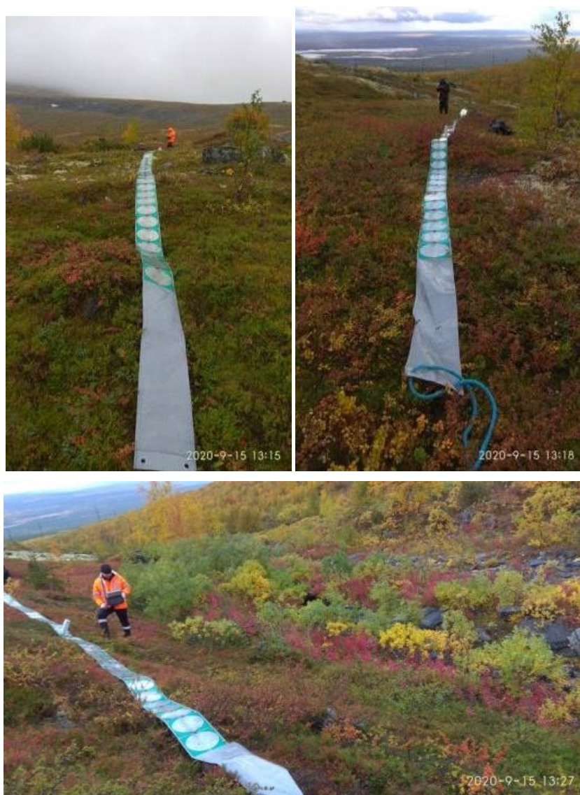
Рис. 4.11. Проведение геофизических исследований на местности, георадар «Лоза-1Н» (антенна 10 МГц)
