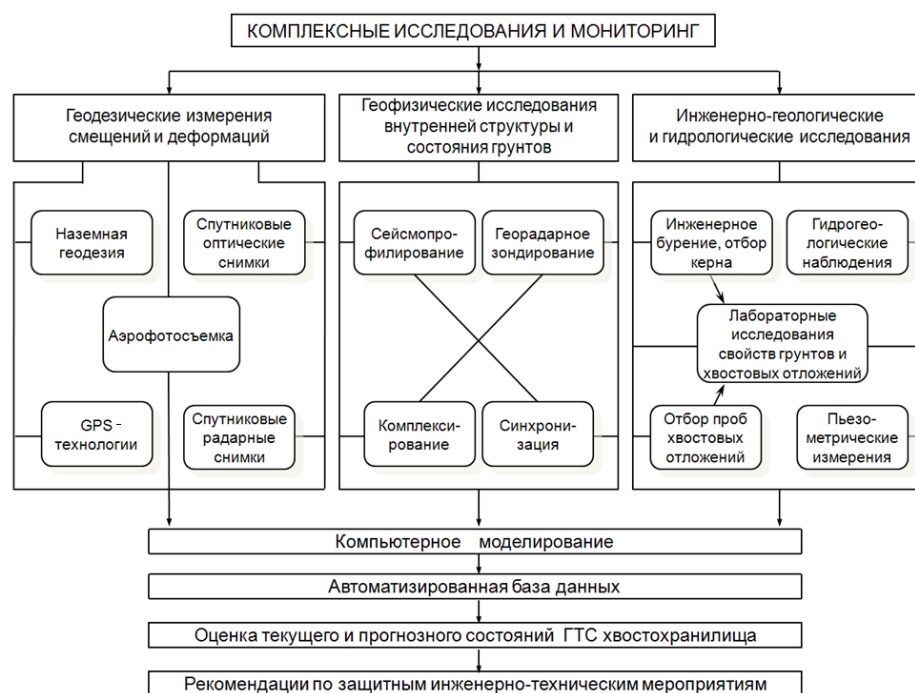
Рис. 2.2. Структура комплексных исследований и мониторинга ГТС хвостохранилища горнодобывающего предприятия [152]
