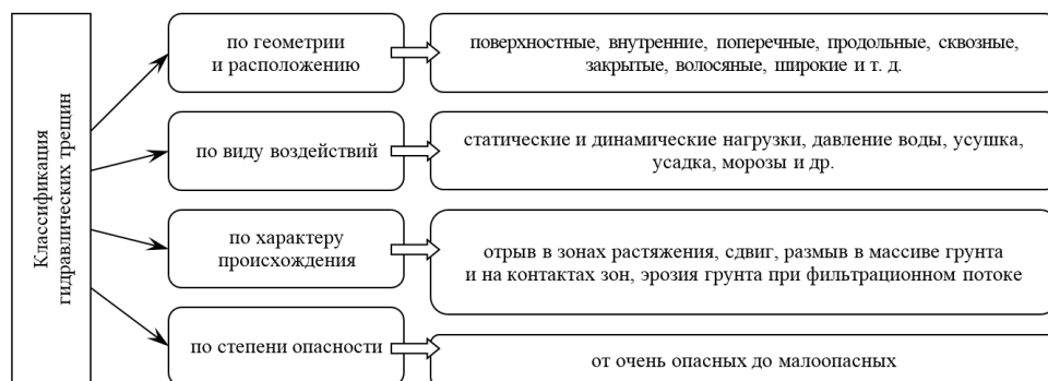
Рис. 1.4. Классификация гидравлических трещин (по [12])
