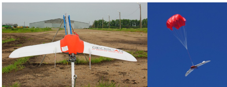
Рис. 3.18. Запуск БПЛА с катапульты (слева) и посадка с помощью парашюта (справа)
