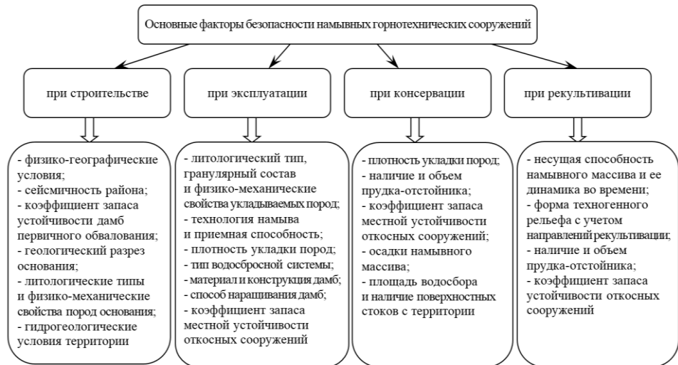
Рис. 1.5. Классификация основных факторов, влияющих на безопасность хвостохранилищ [13]
