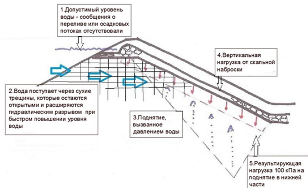
Рис. 5.11. Пошаговый механизм разрушения дамбы Ситу Гинтунг (перевод автора) [274]
