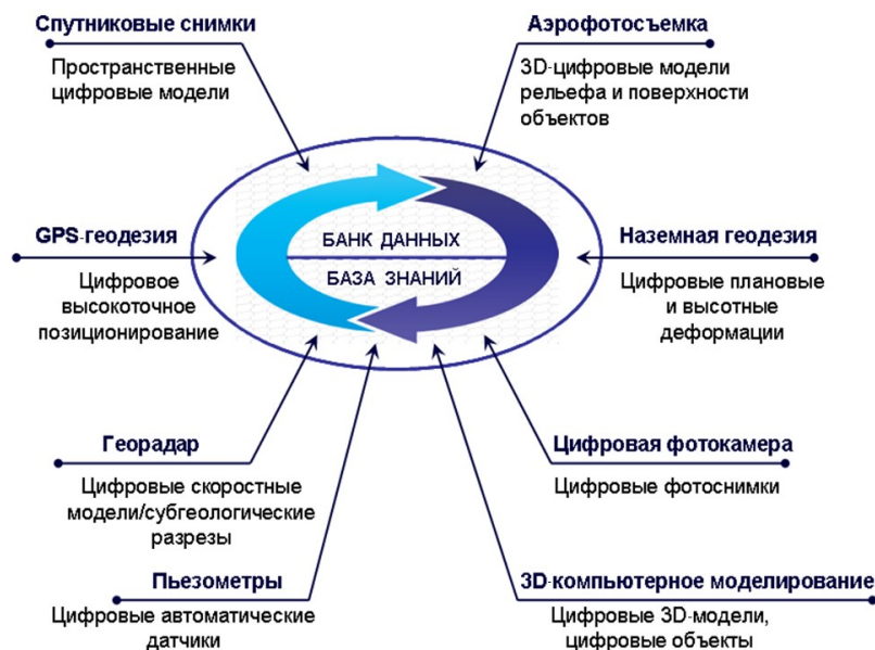
Рис. 3.46. Цифровые технологии в междисциплинарных методах и подходах мониторинга гидрогеомеханического состояния ГТС хвостохранилища
