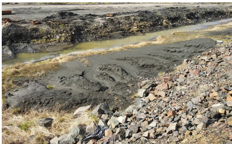
Рис. 5.13. Следы суффозионного выноса хвостовых отложений
