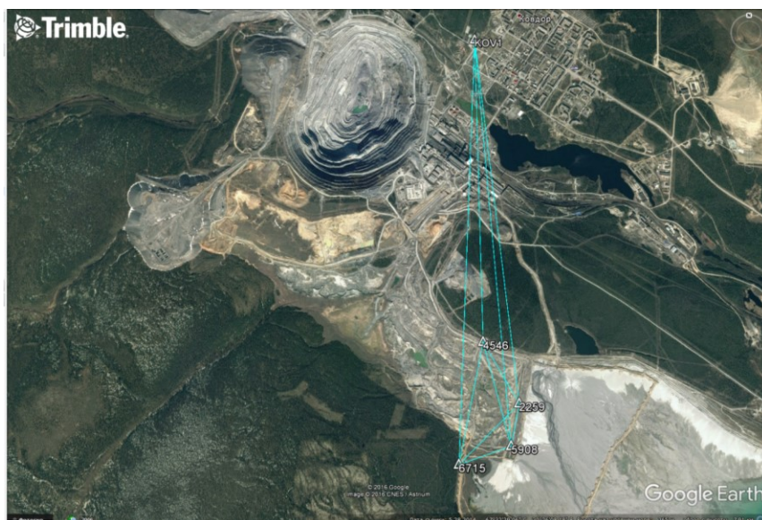
Рис. 3.16. Схема проведения GPS-измерений на ГТС хвостохранилища АО «Ковдорский ГОК»
