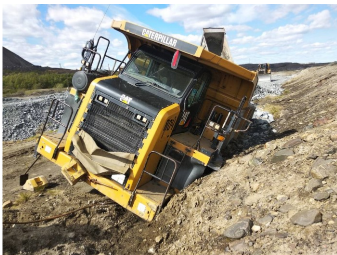
Рис. 5.17. Автосамосвал, пострадавший от локальной деформации
