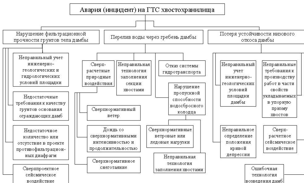
Рис. 1.17. Блок-схема причин формирования аварий (инцидентов) на ГТС хвостохранилища (по [76])
