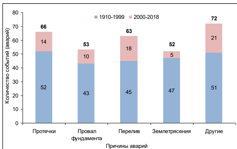
Рис. 1.12. Распределение разрушений по причинам аварий [16–21, 65, 66]
