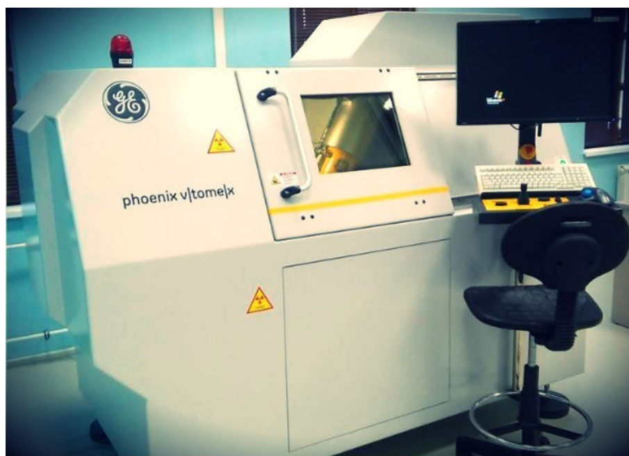
Рис. 2.5. Микро- и нанофокусная исследовательская рентгеновская система для компьютерной томографии General Electric V|tome|X S 240
