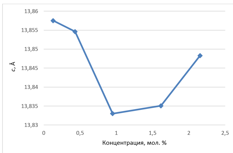
Рис. 3. Концентрационная зависимость периода c элементарной ячейки от концентрации Ce в кристалле \text{LiNbO}_3
