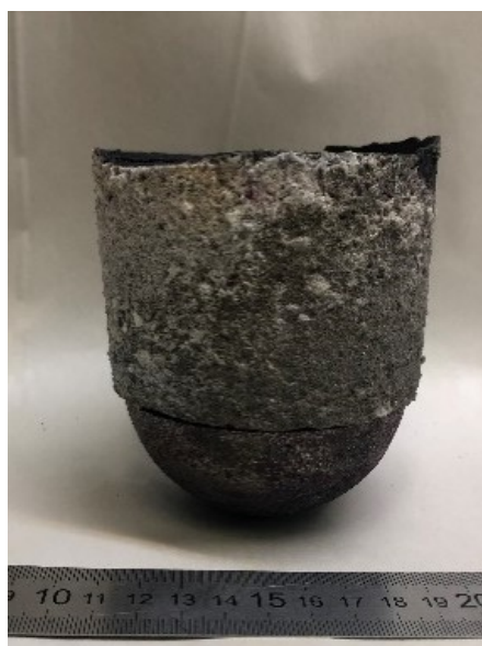
Рис. 2. Полученный слиток с целевой лигатурой Mo–Cr и шлаком на поверхности
