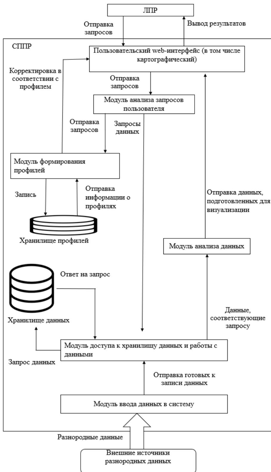
Рис. 1. Обобщённая архитектура СППР с модулем формирования профилей пользователей
