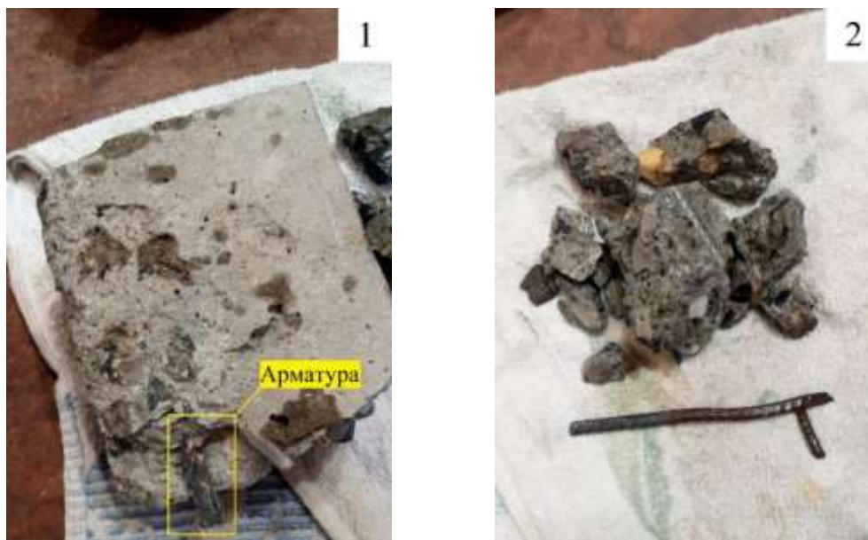
Рис. 5. Высвобождение стальной арматуры из бетона при электроимпульсном воздействии: 1 — образец ЖБИ до ЭИД; 2 — разрушенный образец
