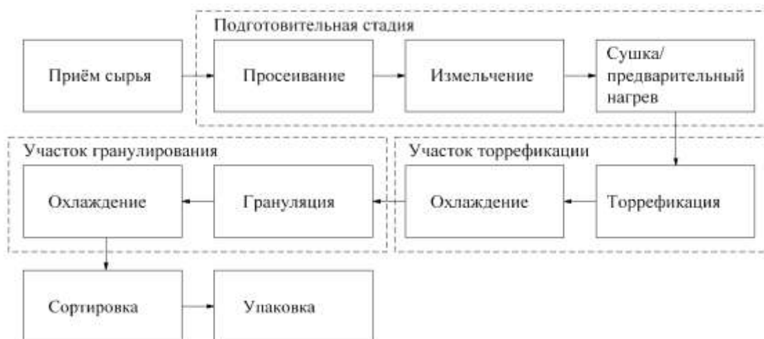
Рис. 4. Общая схема процесса торрефикации Fig. 4. General scheme of the billing process
