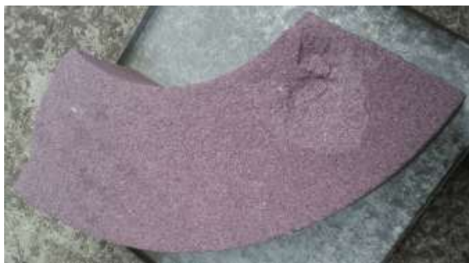
Рис. 2. Образец абразивного кольца из хромтитанистого электрокорунда Fig. 2. Sample of a vitrified grinding wheel made of pink fused alumina with titanium dioxide
