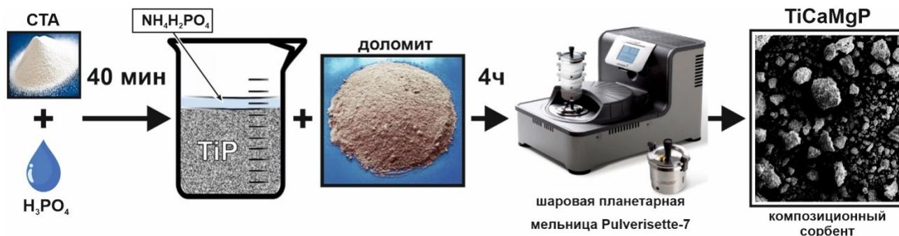
Рис. 2. Схема механохимического способа синтеза композиционного сорбента  $TiCaMgP$
